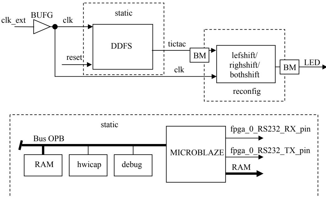
**Figura 28.** Diagrama de bloques de la Auto-Reconfiguración parcial de no periféricos
