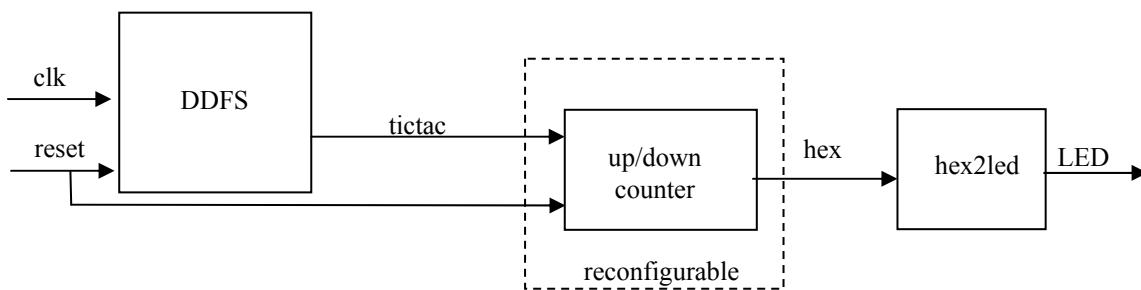
Figura 23. Diagrama de bloques del ejemplo de Reconfiguración Estática con *Virtex-II*
