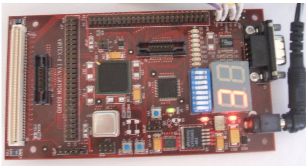
Figura 34. Contador ascendente en la placa *Virtex-II*
