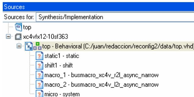
Es importante no añadir los ficheros de código *vhdl* de los componentes del *top* al proyecto (ni siquiera el *MicroBlaze*), ya que se va a sintetizar todo por separado. Esto puede comprobarse porque una vez guardado el fichero *top.vhd*, todos los componentes aparecerán con una interrogación.
