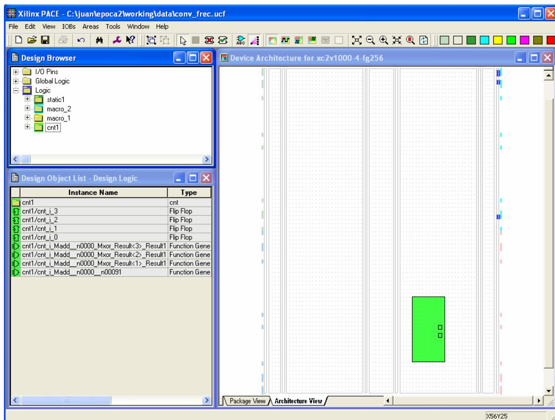
Una vez guardado se edita el *.ucf* y en el que se deben incluir los *area\_groups* de la parte estática y de la reconfigurable. Se localiza el *BUFG* del reloj en *BUFGMUX0P*, y los *buses macro* en la frontera derecha del área reconfigurable.
