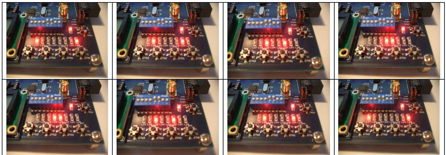
**Figura 31.** Placa *Virtex-4* con *bitstream* parcial *bothshift* tras la auto-reconfiguración
