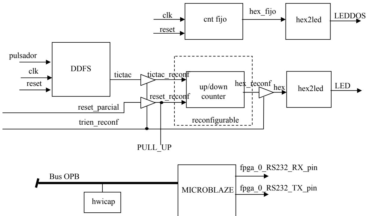
**Figura 27.** Diagrama de bloques del ejemplo de Auto-Reconfiguración con el flujo en diferencias
