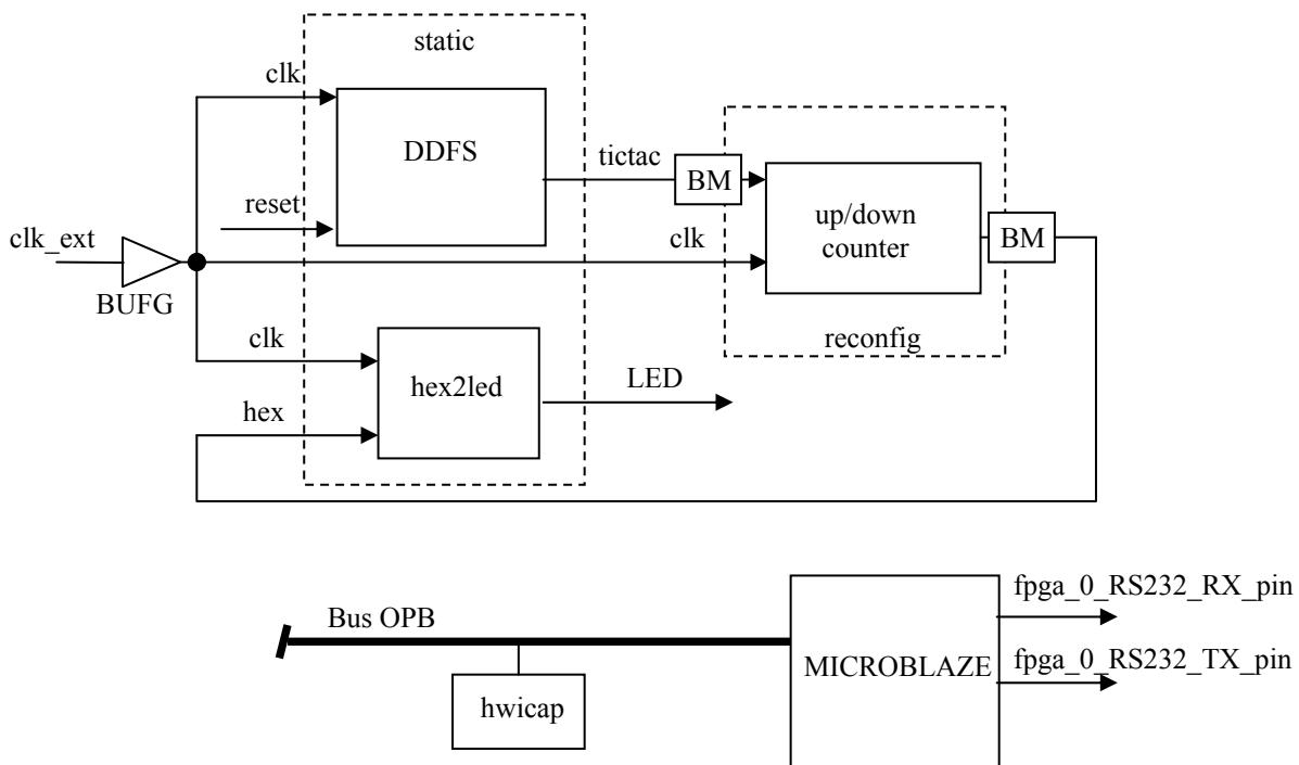
Figura 36. Diagrama de bloques de Auto-Reconfiguración con *Virtex-II*
