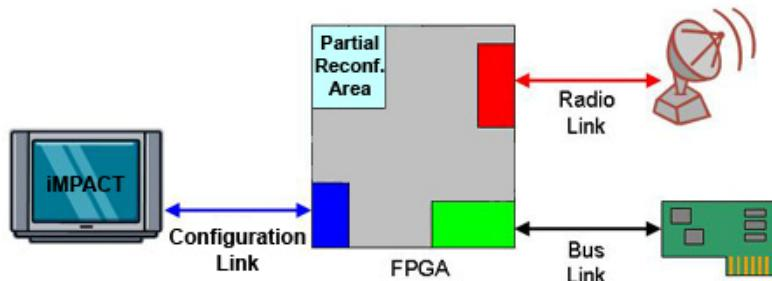
**Figura 7.** Reconfiguración parcial dinámica o activa
