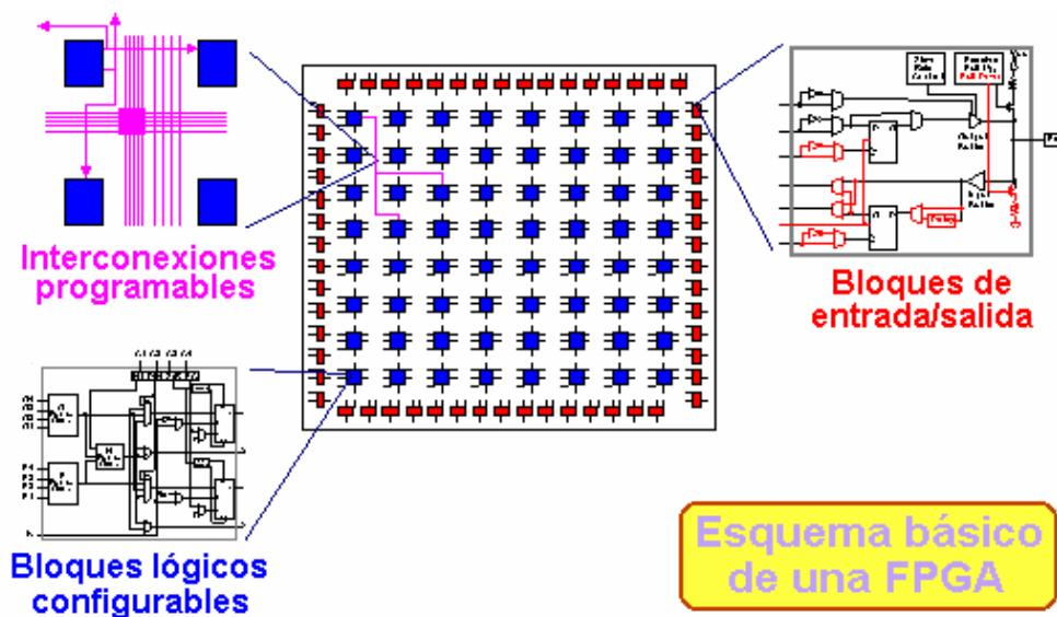
Figura 1. Esquema básico de una *FPGA*
