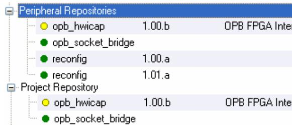
Se puede observar que en el apartado *Peripheral Repositories* se muestran todos los elementos, tanto los periféricos del repositorio (*reconfig*) como los añadidos a la carpeta *pcores* del proyecto (*opb\_socket\_bridge* y *opb\_hwicap*).
