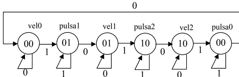
Figura 26. Máquina de estados del divisor de frecuencias *ddfs*
