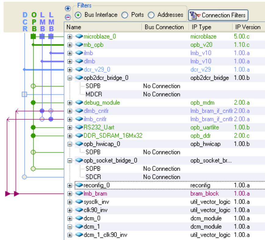
Se puede observar que aparece un nuevo bus *dcr*, un puente entre el bus *dcr* y el bus *opb*, y el *socket* que contiene los *buses macro* y se conectará al módulo reconfigurable.
