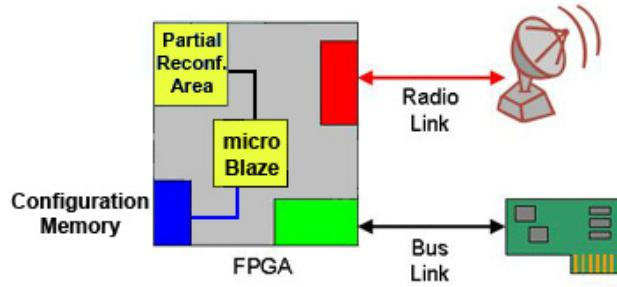
**Figura 9.** Auto-Reconfiguración parcial de periférico
