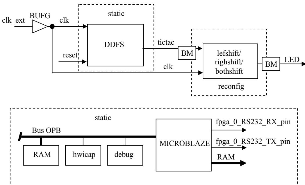
**Figura 37.** Diagrama de bloques de Auto-Reconfiguración con *Virtex-II Pro*
