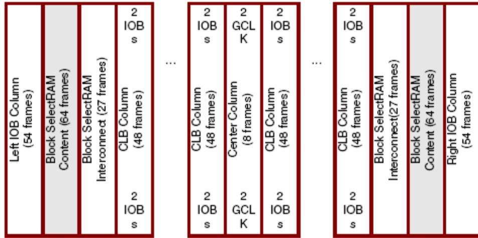
Figura 2. Disposición de las columnas de la memoria de configuración
