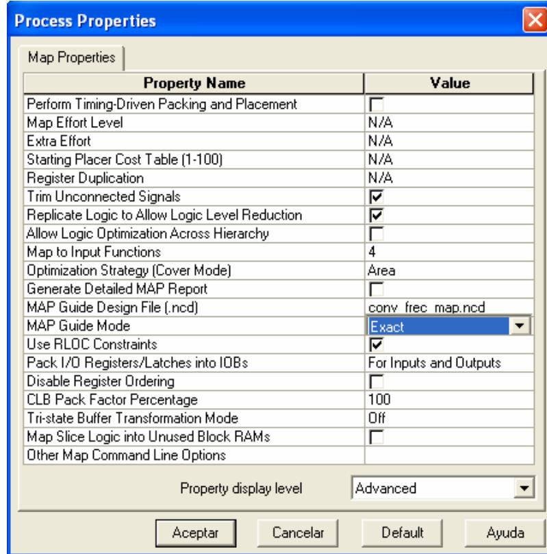
En la pestaña *Process View* se hace clic con el botón derecho encima de *Place & Route*, seleccionando *Properties*. Se selecciona el *PAR Guide Mode* como *Exact*, y en *PAR Guide Design (.ncd)* se selecciona nuevamente el archivo *conv\_frec.ncd* del proyecto anterior.
