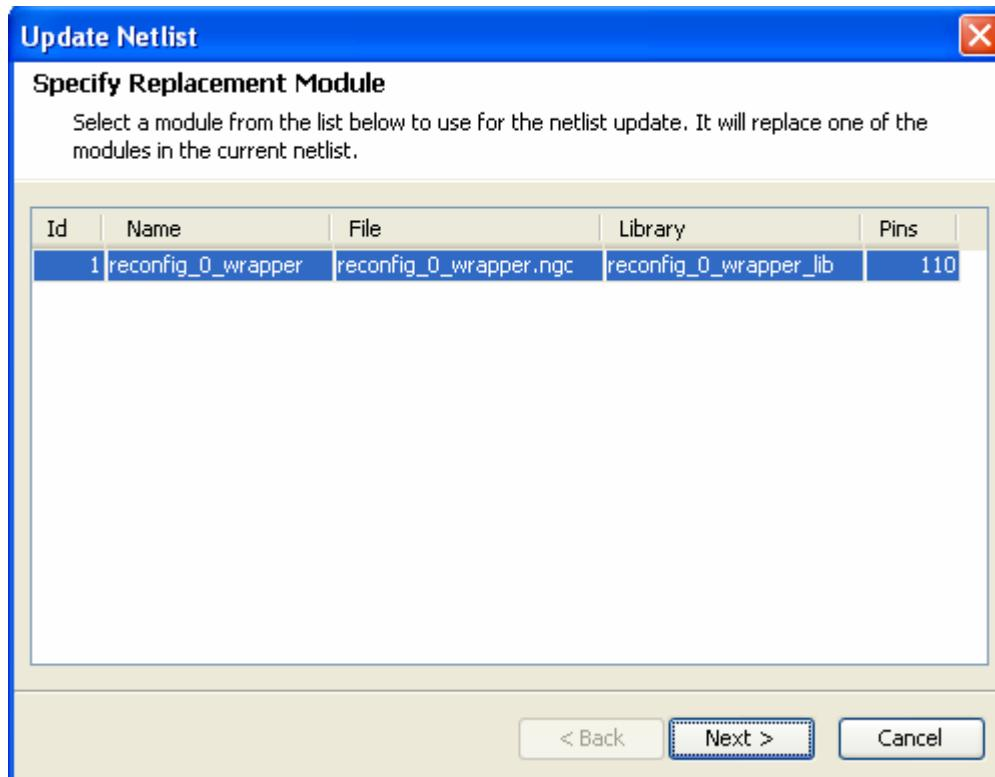
Se selecciona el módulo que va a ser reemplazado (*reconfig\_0\_wrapper*) y se hace clic en *Next* y finalmente en *Finish*.
