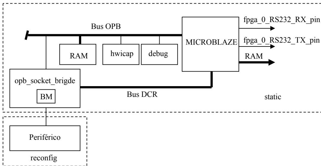
Figura 38. Diagrama de bloques de Auto-Reconfiguración de periféricos con *Virtex-4*
