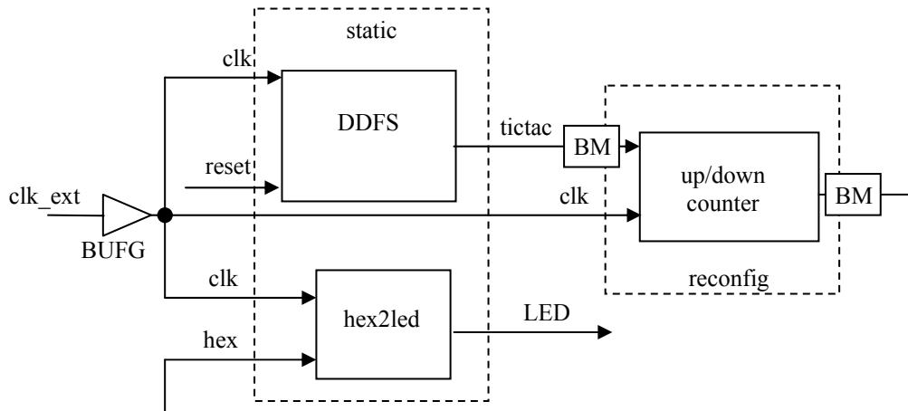
Figura 32. Diagrama de bloques del ejemplo de Reconfiguración parcial
