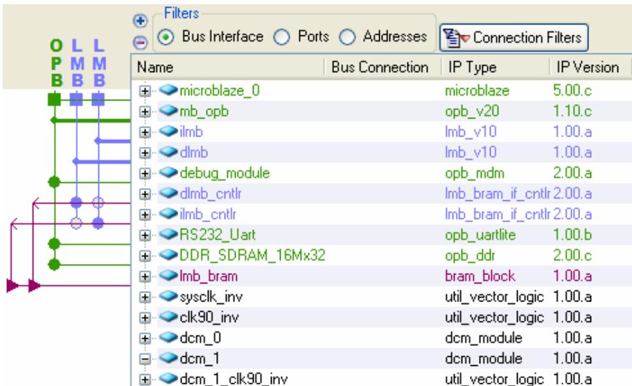
Se añaden los componentes necesarios para la reconfiguración del periférico, buscándolos en el Catálogo de IPs y haciendo doble clic sobre ellos:
