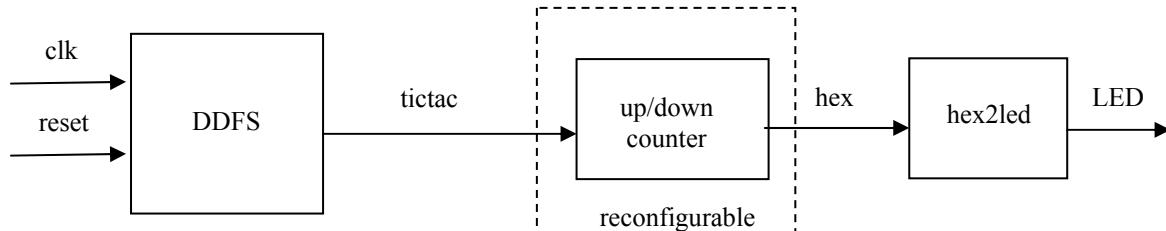
**Figura 24.** Diagrama de bloques del ejemplo de Reconfiguración conservando el estado
