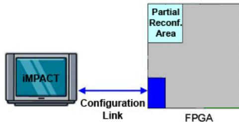
**Figura 6.** Reconfiguración Parcial Estática
