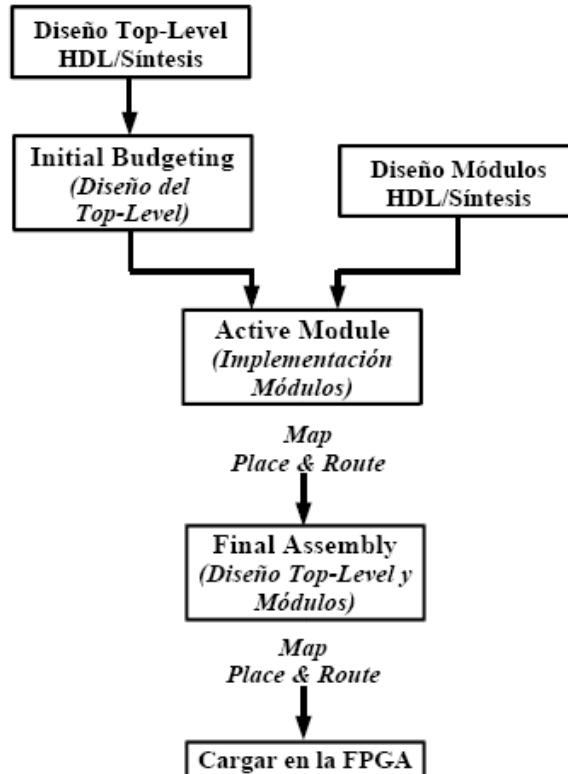
Figura 11. Flujo de diseño Modular
