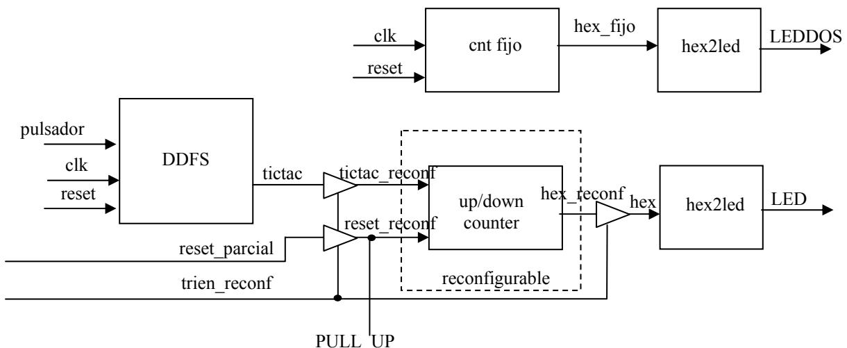
**Figura 25.** Diagrama de bloques del ejemplo de Reconfiguración Parcial Activa
