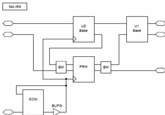
Figura 15. Ejemplo de Diseño reconfigurable con el flujo *EA\_PR*
