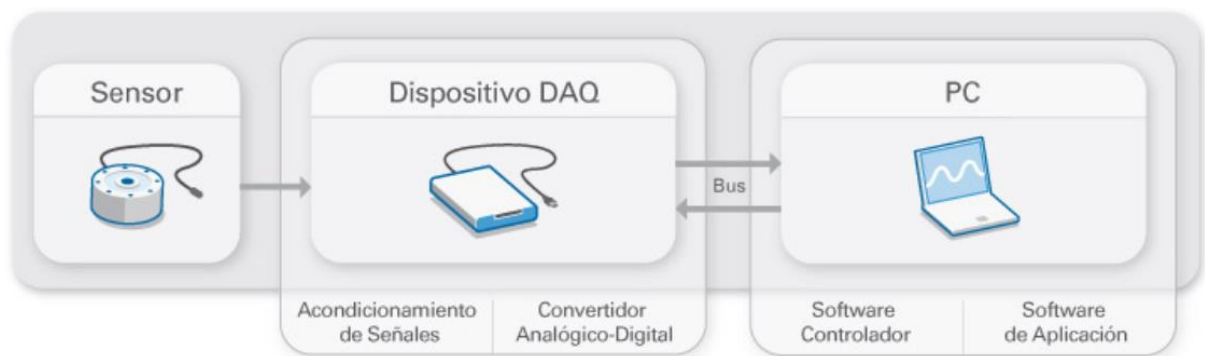
Ilustración 73. Componentes esenciales en sistema de adquisición de datos
