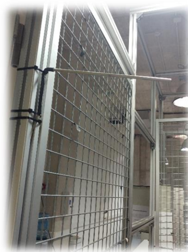
Ilustración 60. Localización de sensor de Tª Pt100 en banco de ensayos
