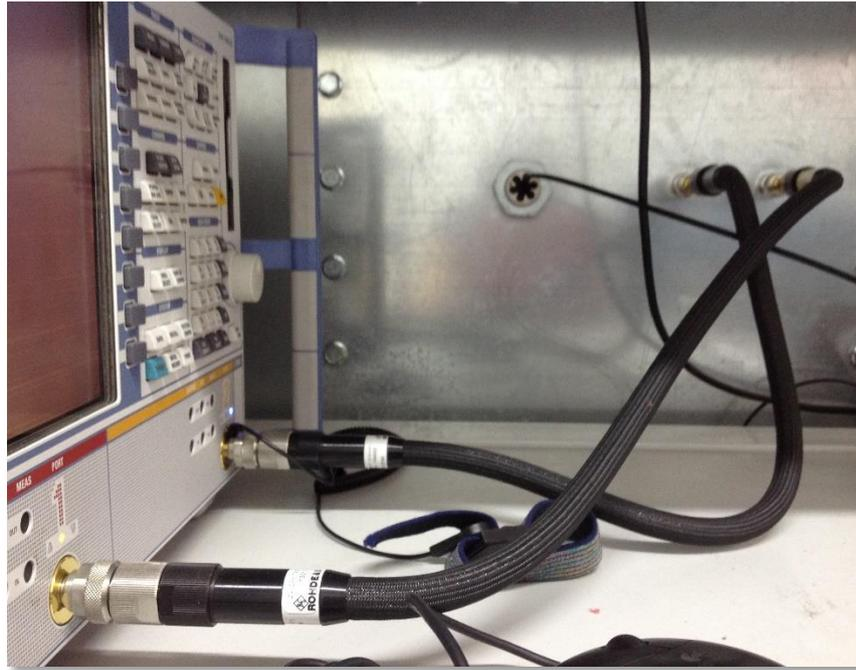
Figura 42: Sondas coaxiales en puerto 1 y puerto 2.
