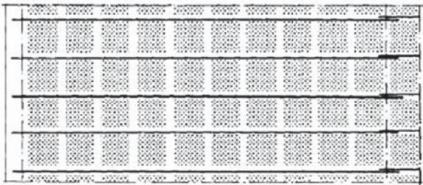
Planta armadura inferior
