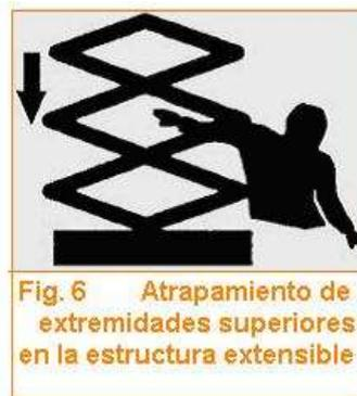
Fig. 6 Atrapamiento de extremidades superiores en la estructura extensible
