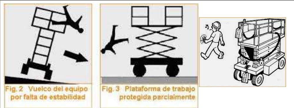
Fig. 2 Vuelco del equipo por falta de estabilidad
