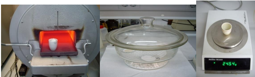
Figura 4 26 horno mufla para conocer el contenido en cenizas.
