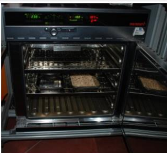
Figura 4 25 secado en estufa 105°C Fuente: http://ise.uc3m.es/biolab/humedad-estufa/
