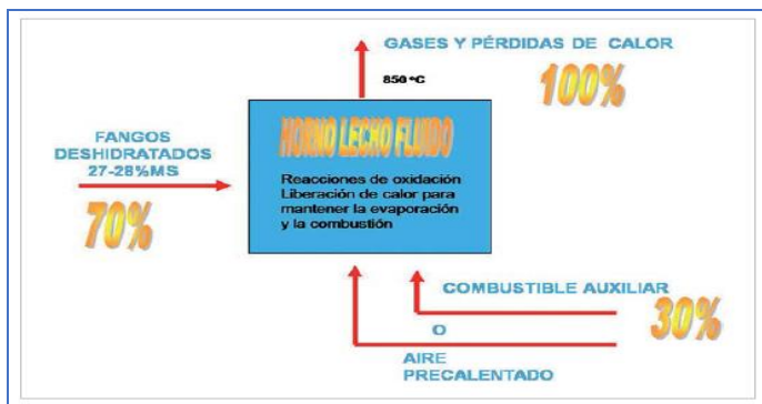
Figura 5.9 balance térmico horno lecho fluido Fuente : Iñaki del Campo, Degremont.
