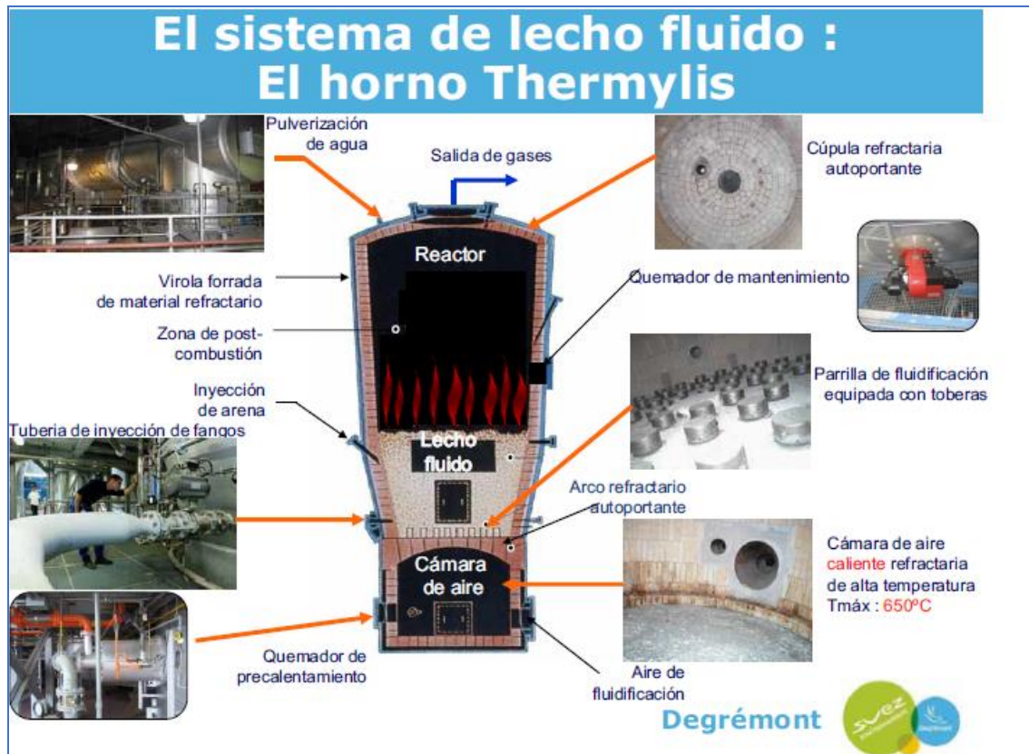
Figura 4 14 El sistema de lecho fluido: El horno Thermylis. Fuente: http://docplayer.es/13960354-El-factor-clave-del-tratamiento-de-fangos-la-energia-inaki-del-campo-director-de-proyectos-degre-mont-iberia.html
