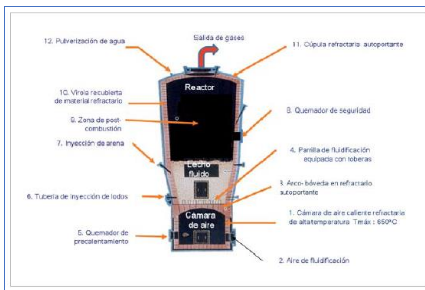
Figura 4 18 esquema del horno de lecho fluidificado Fuente www.degremont.com/
