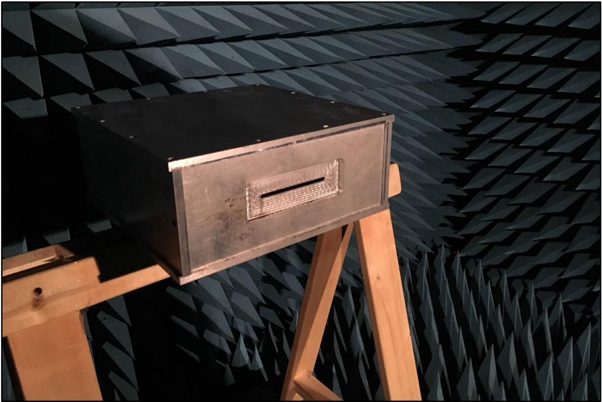
Fig. 20. Emplazamiento de la cavidad A con apertura 1 en la cámara anecoica.
