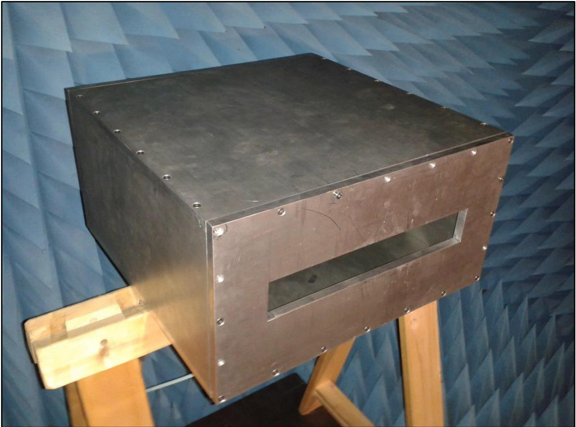
Fig. 18. Cavity B de dimensiones a \times b \times c = 40 \text{ cm} \times 20 \text{ cm} \times 40 \text{ cm} .
