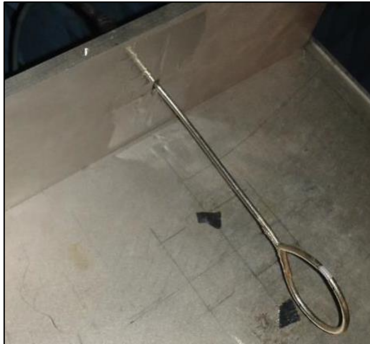
Fig. 15. Sonda magnética: espiral de 4.5 cm de diámetro interior.
