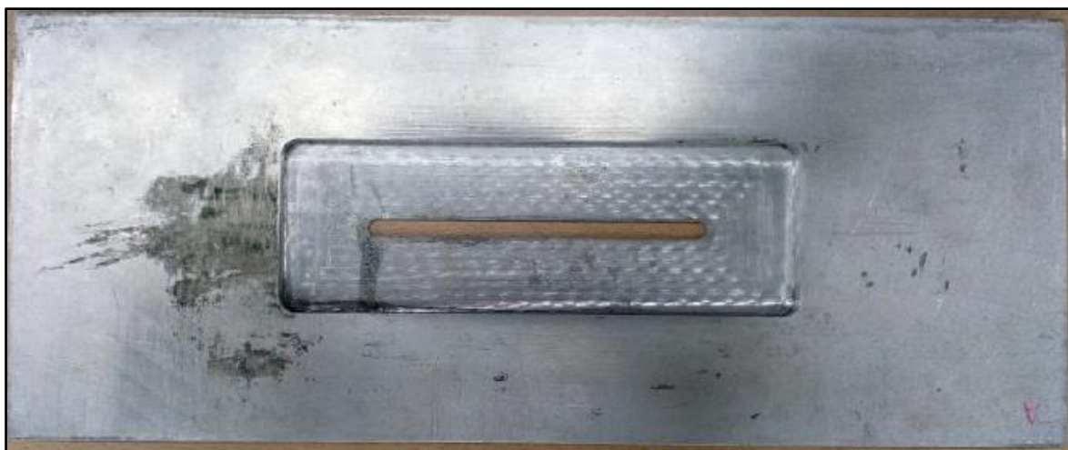
Fig. 19. Apertura 1 de dimensiones 10 \text{ cm} \times 0.5 \text{ cm} (h \times w) .
