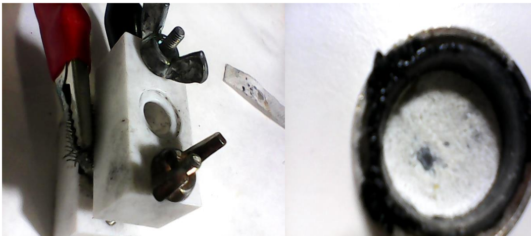
Figura 26. Cápsula contenedor del ánodo
