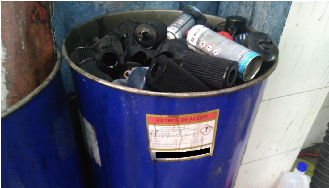
Ilustración 9: Ejemplo de almacenamiento de residuos incorrecto. Detalle
