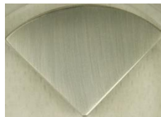
Figura 96. Superficie del aluminio al finalizar el ensayo de corrosión con LEP 102
