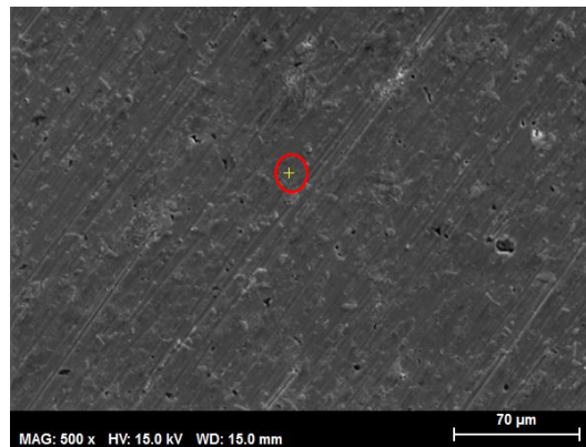
Figura 97. Micrografía SEM a 500x de la superficie del aluminio al finalizar el ensayo de corrosión con LEP 102
