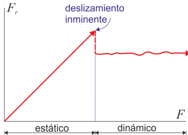
Figura 1. Evolución de la fuerza de rozamiento ( F_r ) al aplicar una fuerza F
