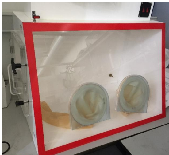
Figura 52. Cámara de aislamiento
