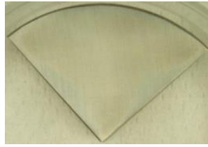
Figura 91. Superficie del aluminio al finalizar el ensayo de corrosión con LMP 102
