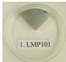
Figura 51. Ejemplo de superficie preparada para corrosión
