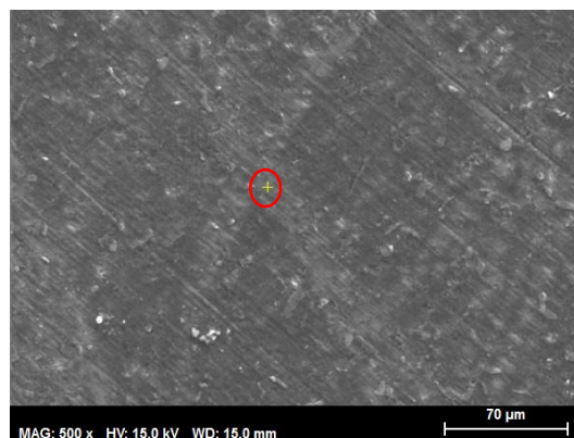
Figura 92. Micrografía SEM a 500x de la superficie del aluminio al finalizar el ensayo de corrosión con LMP 102
