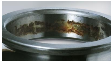
Figura 10. Pieza sometida a desgaste por fretting
