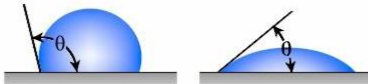
Figura 44. Alteración del ángulo de contacto según si el líquido moja o no
