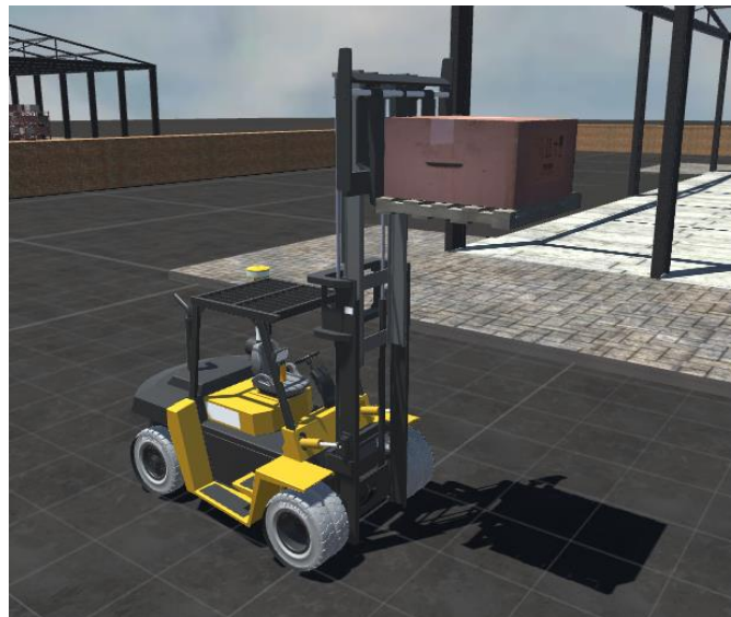
Fig. 88. Carga de 5000 Kg situada a 4 m del suelo
