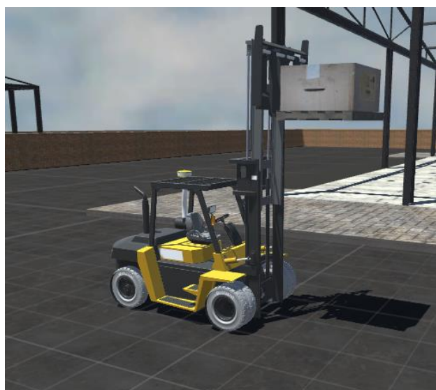
Fig. 79. Carga de 2500 Kg situada a 4 m del suelo
