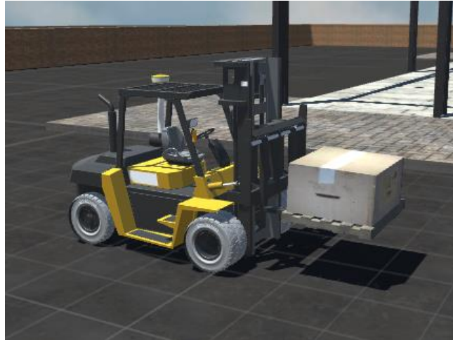
Fig. 86. Carga de 2500 Kg situada a 1 m del suelo
