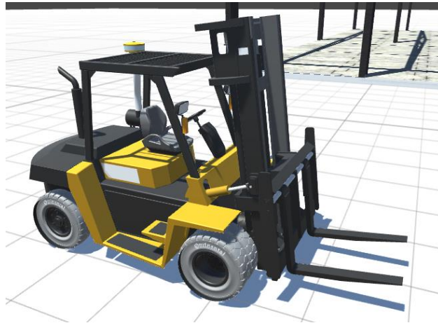
Fig. 53. Inclinación conjunto mástil y horquilla hacia atrás
