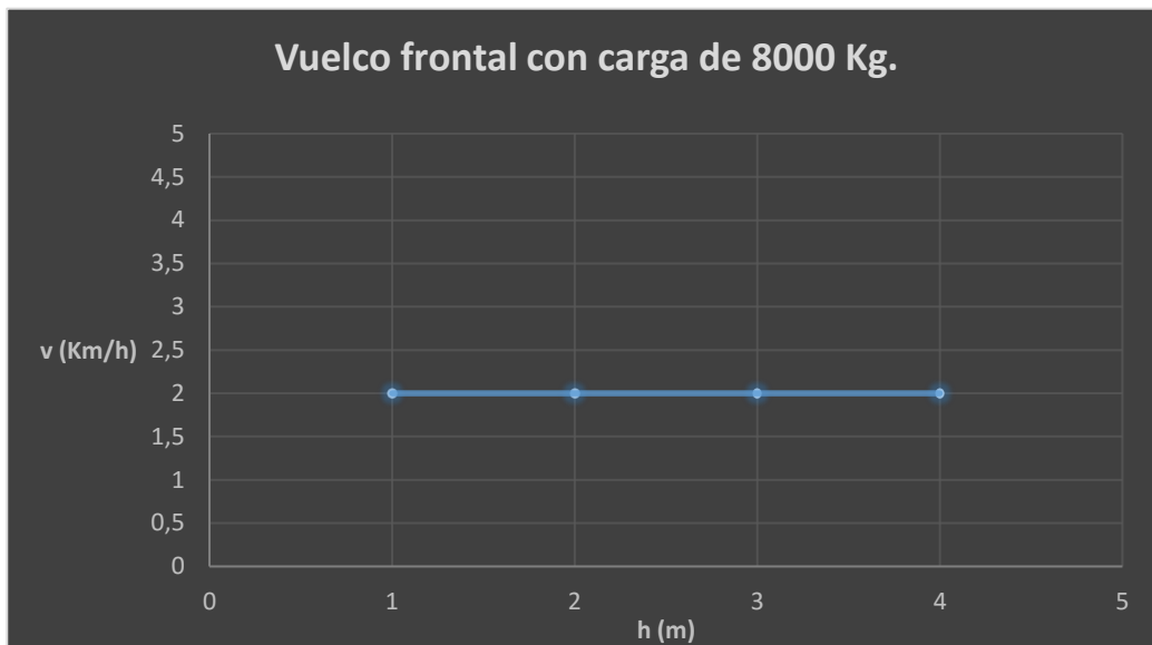
Fig. 84. Gráfica asociada al ensayo de 8000 Kg en referencia al vuelco frontal
