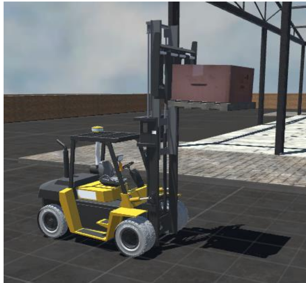
Fig. 81. Carga de 5000 Kg situada a 3 m del suelo
