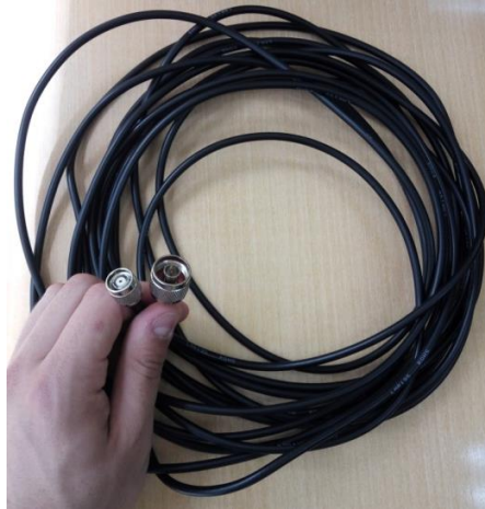
Figura 51. Cable extensor de 10 metros entre el lector y la antena.
