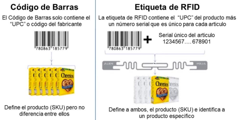
Figura 15. Comparativa de la tecnología RFID con el código de barras para notar que ésta última identifica a un conjunto de productos de un cierto tipo y RFID lo hace de forma individualizada.
