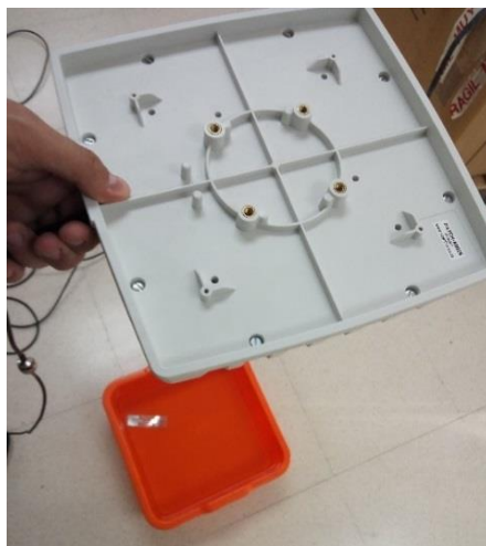
Figura 65. Experimento número 9: con etiquetas inmersas en un barreño de agua salada.
