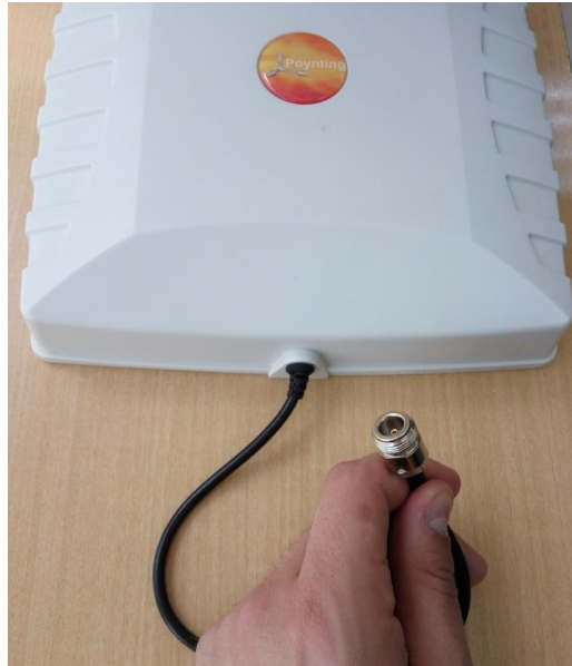
Figura 52. Cable de la antena que irá conectado al cable N-TNC.
