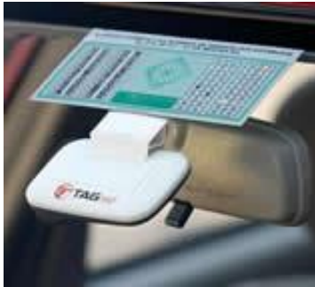
Figura 41. Tag RFID (trabajando a la frecuencia de microondas) pegado en el parabrisas de un turismo para poder pasar por un peaje de carretera pagando sin detener el vehículo (el cual deberá estar registrado en el sistema de peajes).
