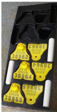
Figura 17. Bolos ruminales y crotales para identificación animal. Estos tag trabajan en la banda LF.
