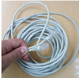
Figura 53. Cable RJ-45 que irá conectado al lector y al ordenador.
