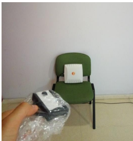
Figura 58. Experimento número 2: con un plástico de por medio.
