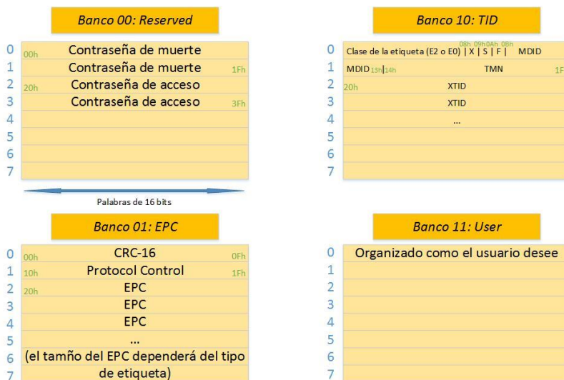
Figura 3. Estructura de la memoria del microchip de una etiqueta RFID.
