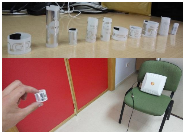
Figura 66. Experimento número 10: con las etiquetas flexibles dobladas.
