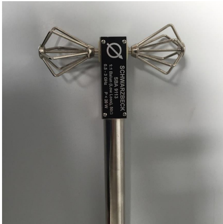
Ilustración 15. Antena SBA 9113 real. Foto realizada en una de las pruebas en el laboratorio SiCoMo.
