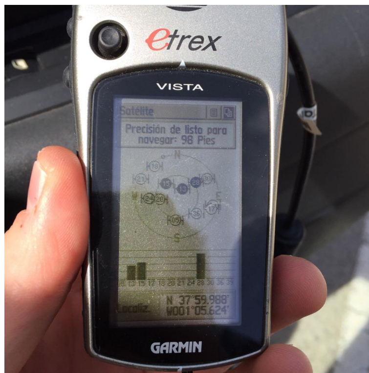
Ilustración 20. Buscando satélites y midiendo coordenadas.
