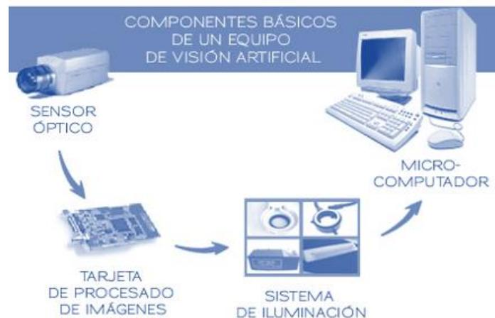
Figura 6: Componentes de un sistema de visión. Fuente: <http://blog.i-mas.com>
