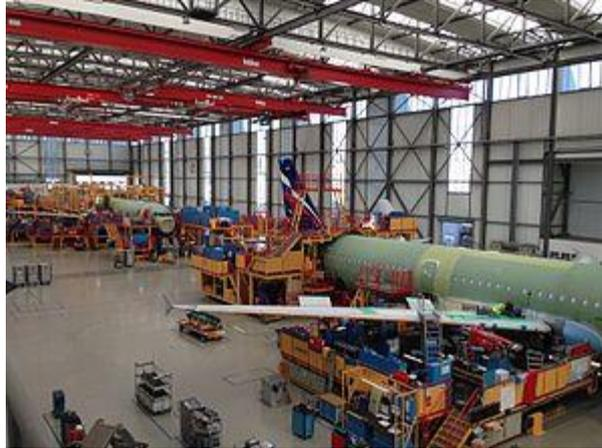
Un [Airbus A321](#) en la línea 3 de ensamble final en la planta Airbus en el Aeropuerto Finkenwerder de Hamburgo.
