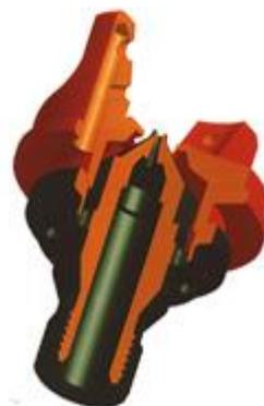
El pico de fluido está fabricado en un acero inoxidable de alta calidad, y junto con el cabezal de aire, completa la sección de aire de pulverización de la pistola. Su tamaño está indicado en milímetros y controla la salida del material.
