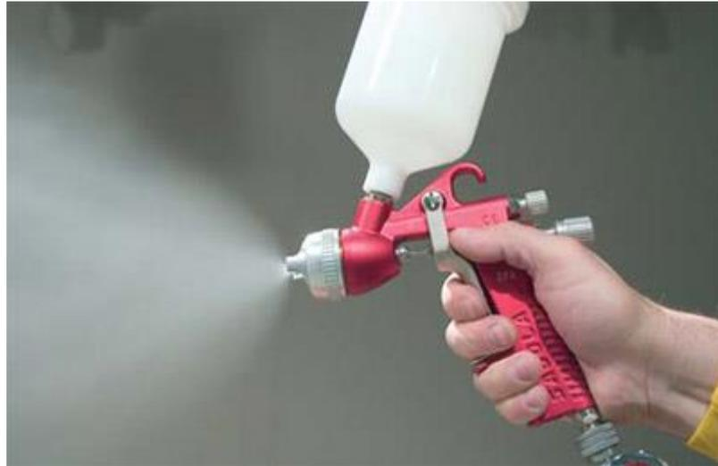
Las pistolas de pintura que se basan en este sistema de pulverización de alta transferencia, pistolas HVLP e híbridas, están fabricadas garantizando el cumplimiento de las normativas. Entre otras cosas estas normativas exigen un nivel de transferencia mínima de producto del 65%. Una propiedad destacable de las pistolas de pintura HVLP es su impresionante ahorro de producto, hay que tener en cuenta que la transferencia de las pistolas de pintura HVLP ya superan el 72%.
