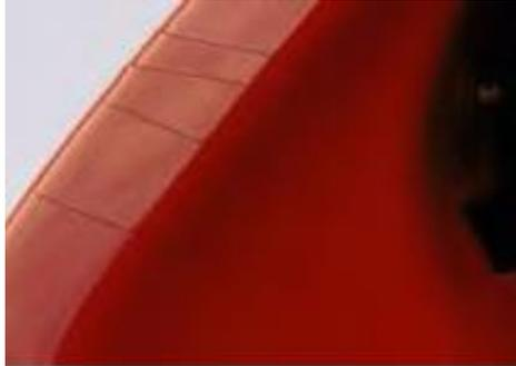
Zonas de rotura en la pintura. También puede agrietarse plástico. Suele producirse principalmente en piezas flexibles. Por ejemplo: alerones traseros de PUR.
