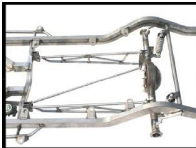
Este chasis normalmente estará configurado por dos vigas de sección tubular, unidas por refuerzos transversales, diagonales, o los dos. A continuación, enumero sus ventajas e inconvenientes:
