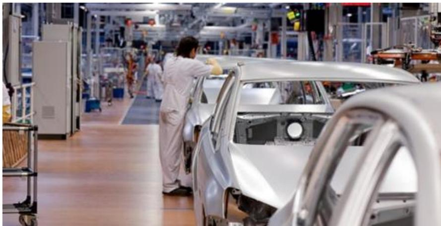
Al finalizar el proceso de ensamblaje del chasis, se montan a la carrocería las partes móviles y pasan un control de calidad para verificar que todo esté en marcha antes de pasar a pintura.
