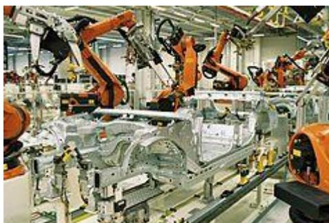
Soldadura por puntos de la carrocería del [BMW Serie 3](#) por robots industriales en la planta de la empresa BMW en [Leipzig](#)
