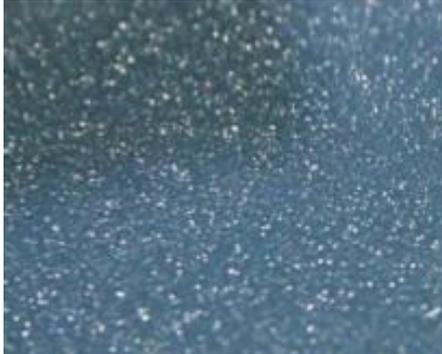
Gotitas de niebla de pulverización del proceso de pintado finamente pulverizadas sobre la superficie o no absorbidas completamente en la película de pintura.
