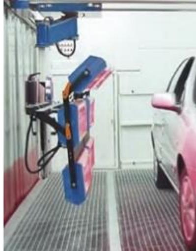
Con el uso de esta tecnología, obtenemos secados de pequeñas superficies en cortos periodos de tiempo. Además, implica una ostensible reducción del consumo de energía dentro del taller pues para secar una o dos piezas se ha de consumir, en una cabina, la misma energía que para un coche completo.
