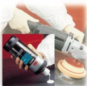
El tamaño y la capacidad de corte del abrasivo seleccionado suele depender del tipo de pintura que sea e incluso de su color. Se suele utilizar un abrasivo algo más fino cuando se trabaja sobre colores oscuros en los que es difícil eliminar marcas sin que queden zonas veladas.
