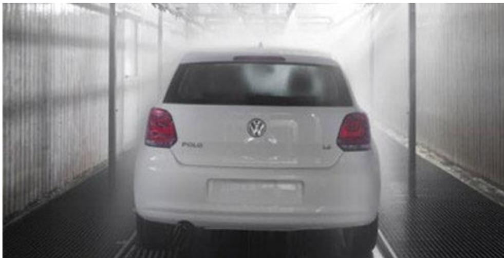
En la siguiente fase, se realizan 2 pruebas: la de lluvia, que consiste en detectar posibles entradas de agua al habitáculo por algún mal ajuste y, si existe, tratar de arreglarlo. Por fin, se pasa a la pista, donde se le exigen más de lo que se exigiría en un uso normal diferentes parámetros a los elementos (como frenos, amortiguación, dirección...) en un circuito cerrado, en
