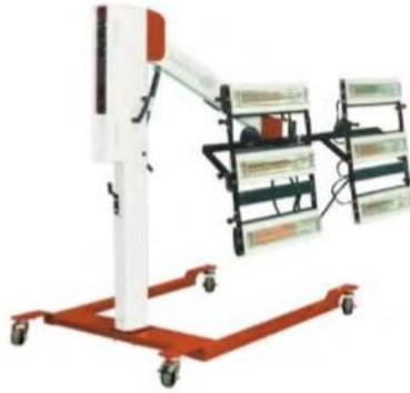
Es conveniente realizar el secado en dos etapas: una facilita la evaporación del disolvente y otra, más elevada y prolongada que endurece la superficie.
