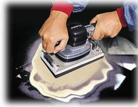
En zonas planas, y de gran superficie se recomienda el uso de máquinas vibradoras y en zonas curvas el lijado debe realizarse con máquinas rotoorbitales. En las zonas irregulares complicadas en las que no es posible maniobrar correctamente con una máquina, el lijado debe realizarse a mano, bien con esponjas bien con rollos almohadillados.
