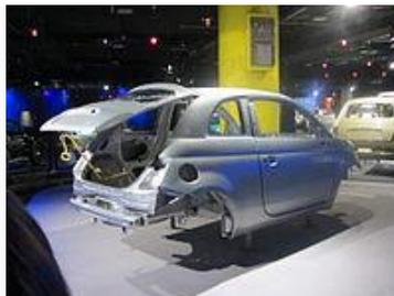
Carrocería monocasco (o autoportante) de un Fiat 500
