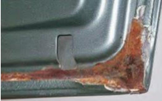
Daños en la pintura que se muestran en forma de elevaciones, similares a ampollas, de forma irregular. Si las ampollas se rompen, las manchas/acción de la corrosión es claramente visible.
