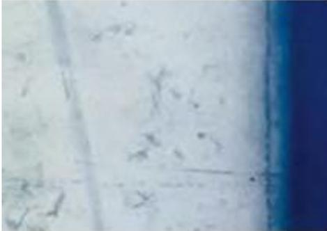
Descomposición de los aglutinantes (resinas) con la consiguiente aparición del pigmento en la superficie de la pintura.
