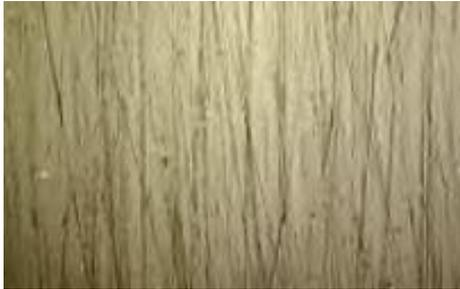
Arañazos finos en forma de franjas, con frecuencia paralelos, que con los tonos de color oscuros resultan especialmente visibles. Las superficies pierden brillo y se vuelven grises.
