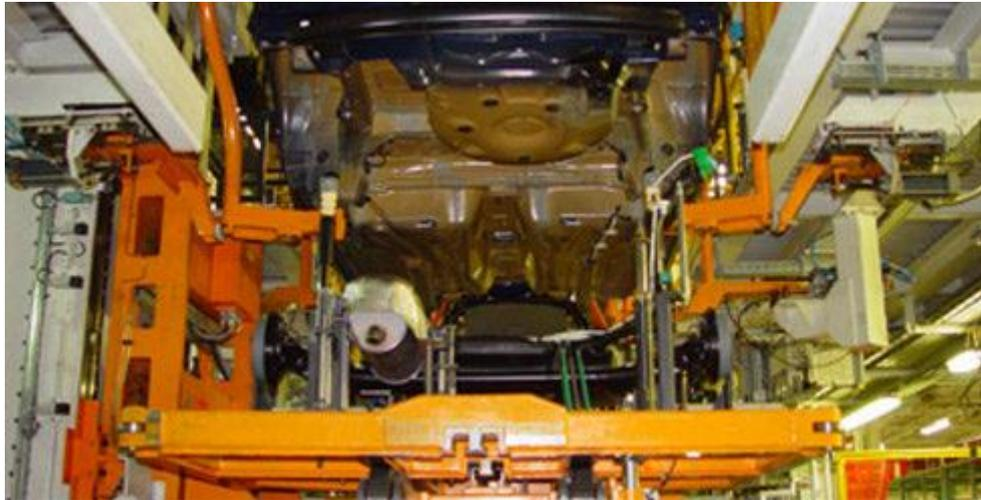
A partir de aquí, ya se empiezan a montar todos los elementos que le quedan al coche, como el frontal (que, se compone del radiador, faros, etc.), las puertas, volante, asientos, ruedas... Y justo cuando se termina de montar por completo, se le ponen a nivel los líquidos vitales del coche, y ya estará listo para pasar a la siguiente fase.
