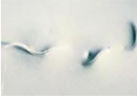
Son pequeñas elevaciones irregulares en la película de pintura que se producen debido a partículas extrañas (por ejemplo, polvo) de diferente tamaño, forma, tipo y distribución.
