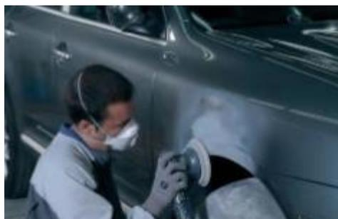
Algo que se debe tener muy en cuenta y que no todos valoran en su justa medida es la colocación de la lijadora, sobre todo la circular, en reposo ya que, si se deja sobre una superficie dura en contacto con el plato, el peso de la máquina va a dar como resultado una torsión del eje y será el causante de las conocidas como “aguas”, es decir ondulaciones en la superficie debido a ese deterioro; ningún producto, sea masilla, sea aparejo, genera aguas de por sí.
