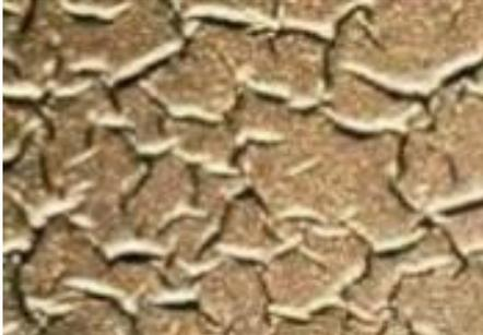
Hinchamiento y levantamiento de las capas más profundas causado por las sucesivas capas durante el proceso de pintado o el de secado.
