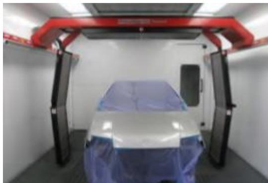
Con esta tecnología, no es la temperatura la que seca la pintura sino esa onda electromagnética especial que activa el proceso de reticulación de dicha molécula, de forma instantánea. Siempre que se utilicen los infrarrojos se debe de empezar por el principio del proceso de reparación, desde la masilla hasta la pintura de acabado.
