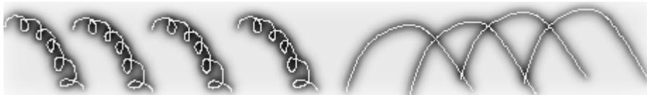
Marcas de lijado con microabrasivos a máquina.
