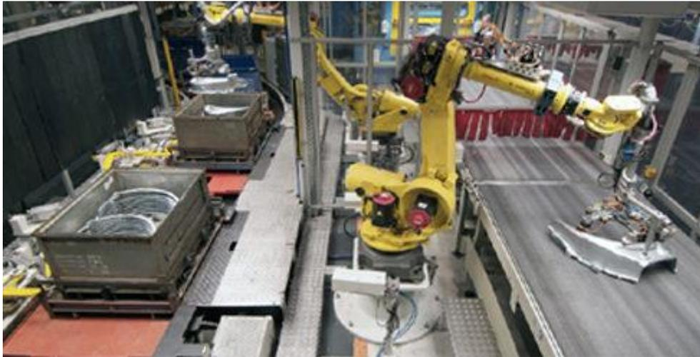
Cuando se quiere hacer otra pieza, se debe realizar un cambio de troqueles, para ello, un proceso automatizado se encarga de dicha tarea y, en un tiempo **no superior a 7 minutos**, la prensa puede volver a estar en funcionamiento.
