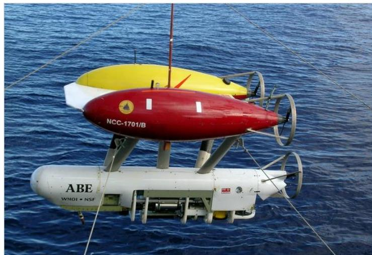
*Figura 1: Explorador autónomo submarino*
