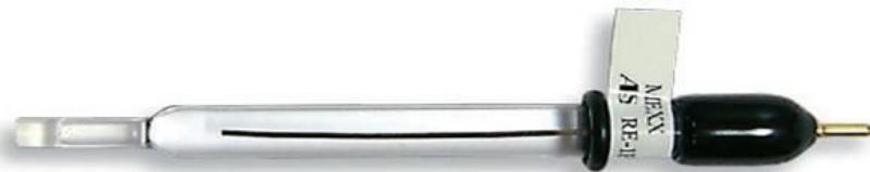
Figura 3. 5 Electrodo de referencia Ag/AgCl 3 M KCl
