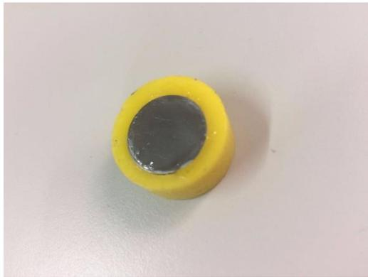
Figura 4. 10 Probeta con capa fina de Dci
