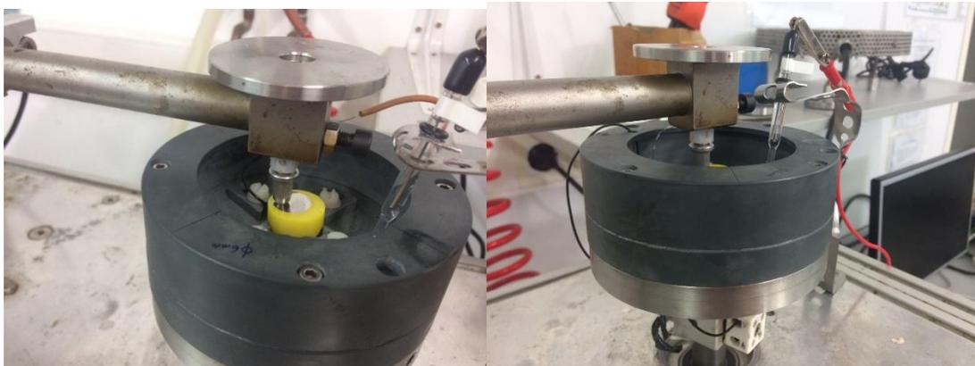
Figura 4. 9 Distintas vistas del montaje del vaso del tribómetro
