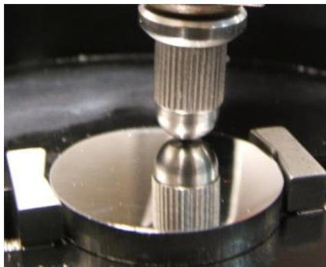
Figura 3. 4 Punzón con bola sobre probeta
