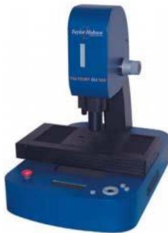
Figura 3. 18 Perfilómetro óptico Taylor Hobson Talysurf CLI 500
