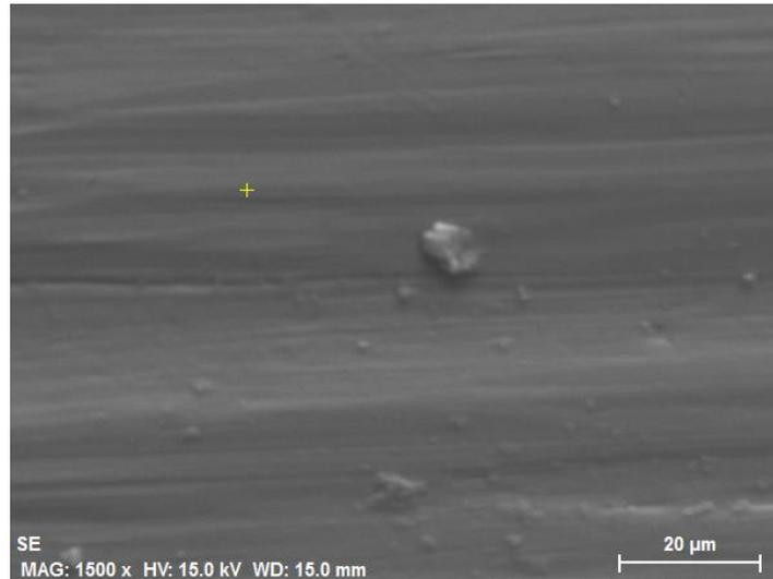
Figura 5. 10 Micrografía SEM de la superficie de la probeta a 1500 aumentos a 60 rpm
