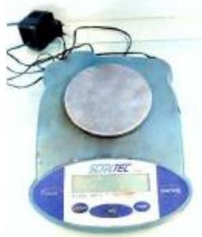
Figura 3. 11 Balanza Scaltec SPB 53
