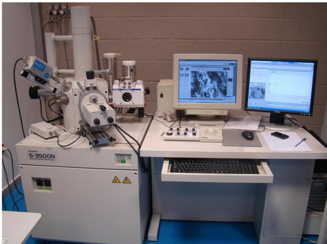
*Figura 3. 22 Microscopio electrónico de barrido (SEM)*
