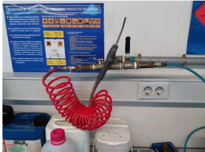
Figura 3. 8 Pistola de aire comprimido
