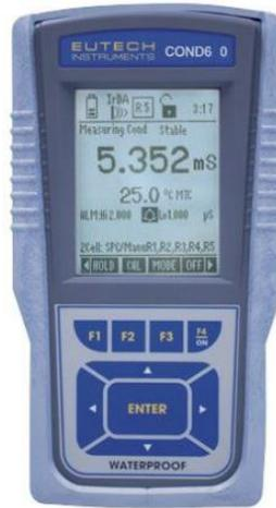
Figura 3. 13 Medidor de conductividad cond600
