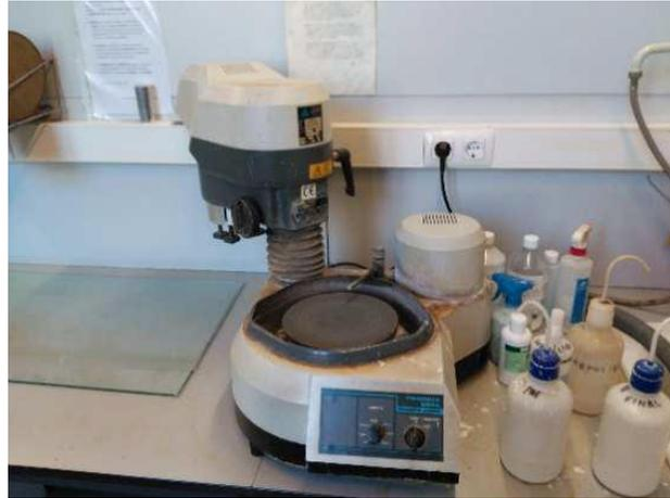
Figura 3. 7 Pulidora metalográfica
