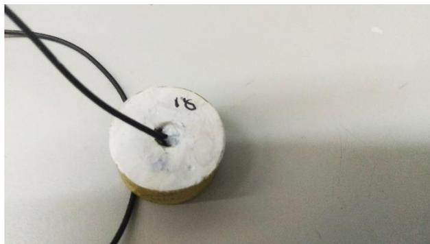
Figura 4. 2 Superficie inferior de la probeta aislada
