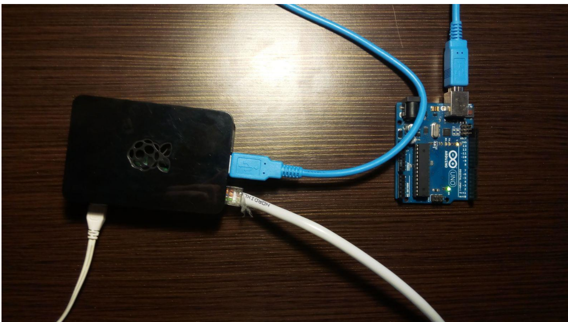
Figura 3.2 Raspberry Pi conectada a Arduino UNO
