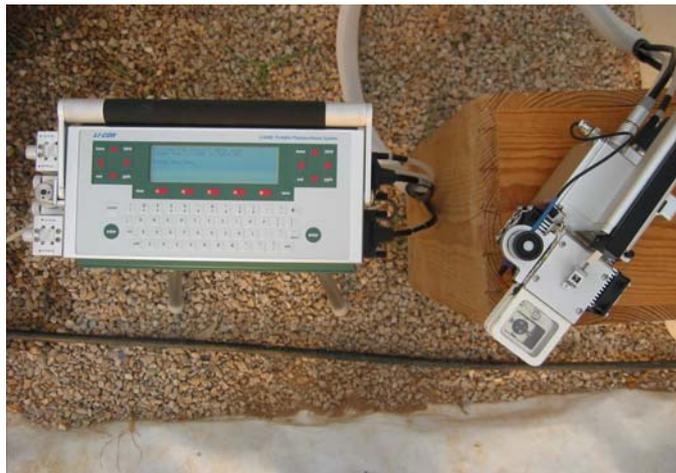
**Fotografía 5.1.** Medidor de fotosíntesis LI-COR, mod. LI-6400.
