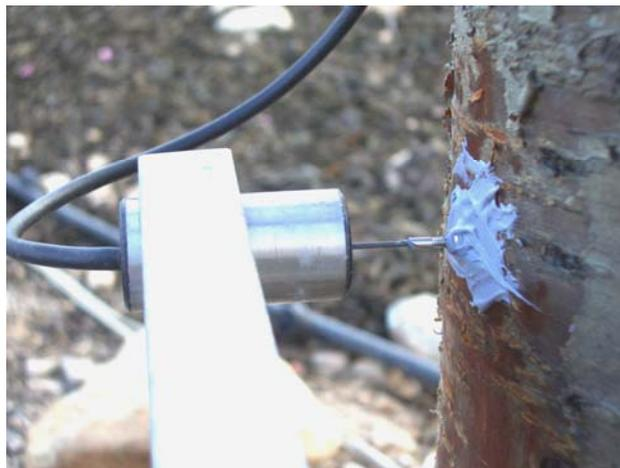
**Fotografía 4.4.** Detalle de la ubicación de un sensor LVDT (linear variable differential transformer).
