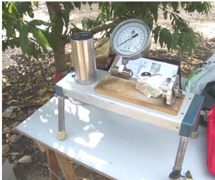
**Fotografía 4.3.** Cámara de presión para la medida de potencial hídrico.
