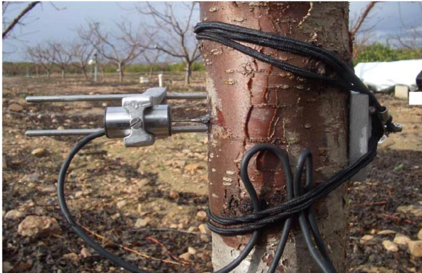
**Fotografía 3.1.** Sensor LVDT para de medida de las variaciones del diámetro del tronco y portasensor.
