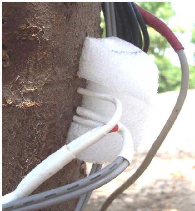
**Fotografía 4.5.** Detalle de la ubicación de un sensor de flujo de savia.
