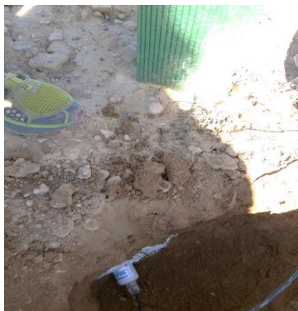
Ilustración 8. Mediciones en suelo con Hydraprobe II
