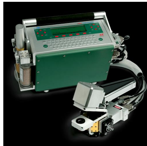
Ilustración 9. A) Equipo de medida del potencial de tallo: cámara de presión (modelo 3000, Soil Moisture Equipment Corp.) y b) Equipo de fotosíntesis portátil (Li-6400, Li-Cor, Lincoln, NE, EEUU)
