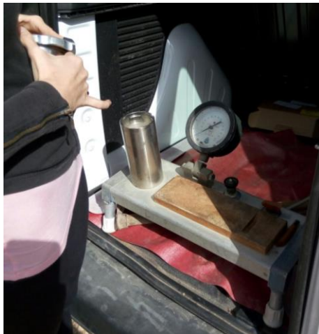
Ilustración 9. A) Equipo de medida del potencial de tallo: cámara de presión (modelo 3000, Soil Moisture Equipment Corp.) y b) Equipo de fotosíntesis portátil (Li-6400, Li-Cor, Lincoln, NE, EEUU)
