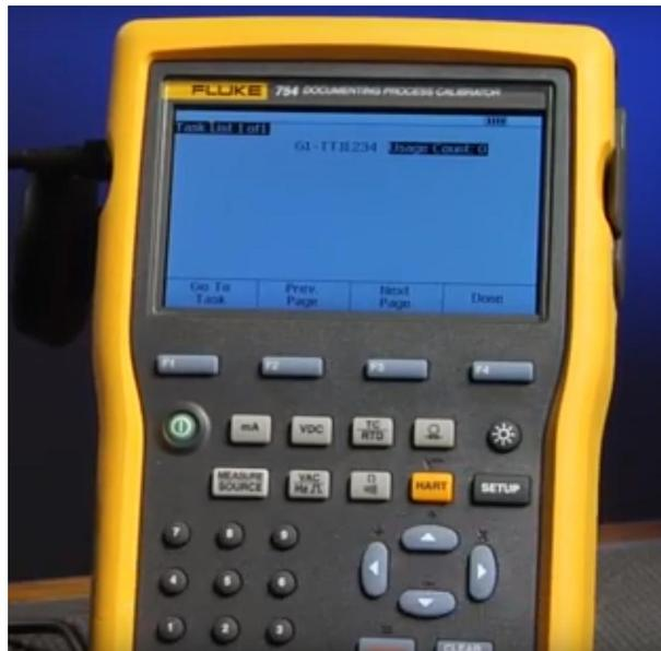
Figura 3.18: Tarea cargada en calibrador Fluke 754
