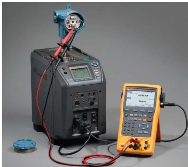
Figura 3.34: Calibración transmisor y sensor primario
