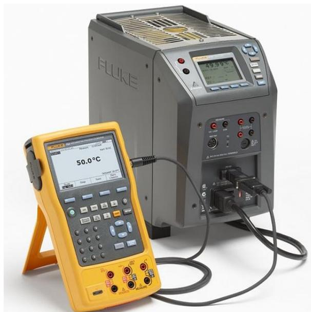
Figura 3.9: Calibrador Fluke y Pozo conectados
