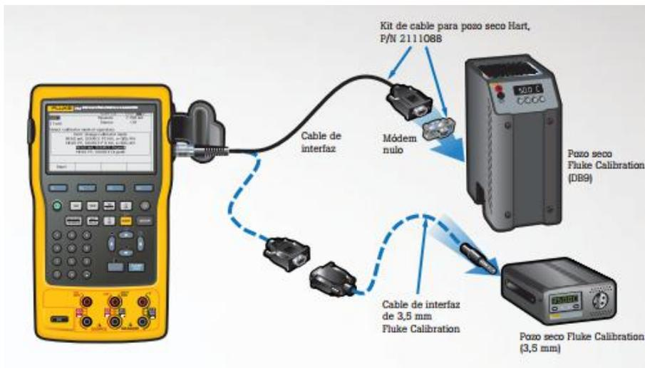
Figura 3.35: Esquema de conexión en bloque
