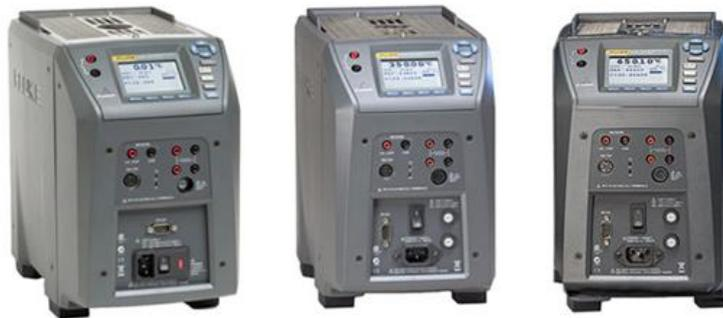
Figura 3.5: Hornos de calibración de la serie 9140 de Fluke
