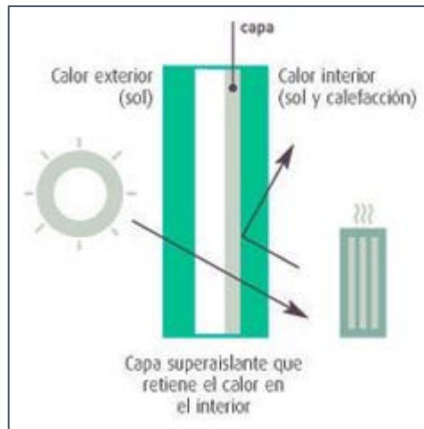
Figura 44. Esquema funcionamiento vidrio de baja emisividad
