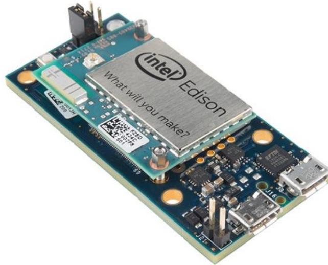
Ilustración 1.4. Mini Breakout Board
