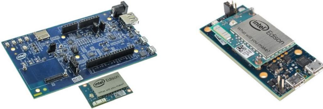
Ilustración 3.5. Placas de desarrollo Arduino Kit y Mini Breakout Board para Intel Edison
