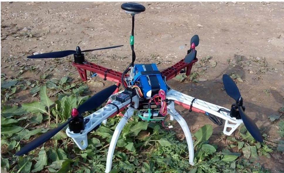
Ilustración 6.5. Drone F450 con el prototipo
