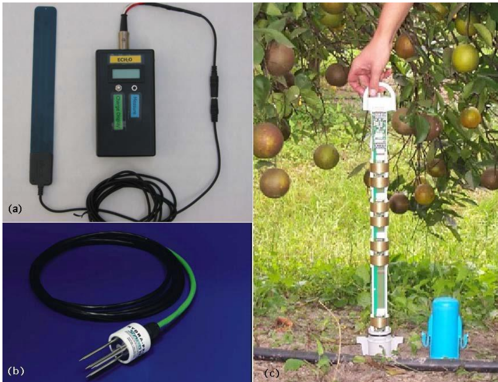
Figura 2-4. Sondeas FD (Dominio de la Frecuencia): a) Placa plana cubierta de aislante; b) Barras cilíndricas; c) Anillos (Muñoz-Carpena et al. 2004).
