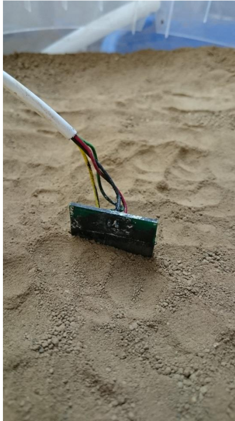
Figura 5-8. Vista detallada del sensor enterrado en el recipiente de calibración.
