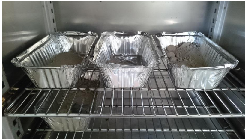
Figura 5-11. Muestras de suelo secando en el horno.
