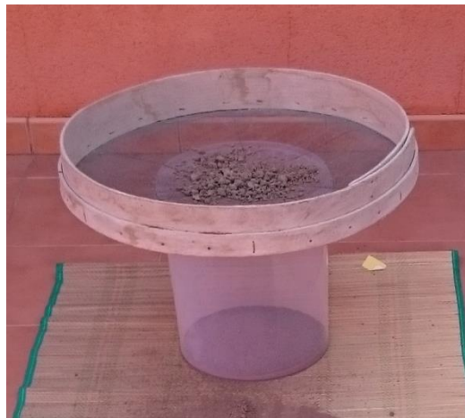
Figura 5-6. Proceso de cribado del suelo seco.
