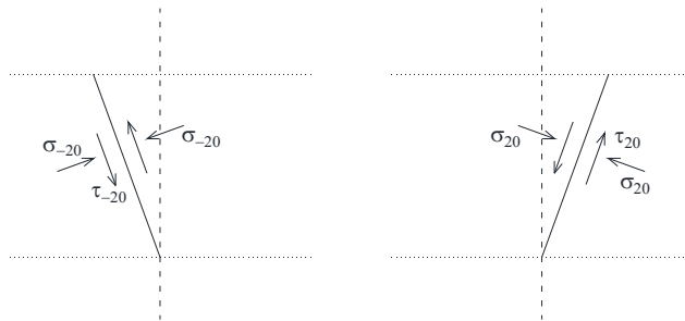
Figura 4.22c. Sentido de las tensiones normales y de corte en los planos \pi_{\beta=20^\circ} y \pi_{\beta=-20^\circ}
