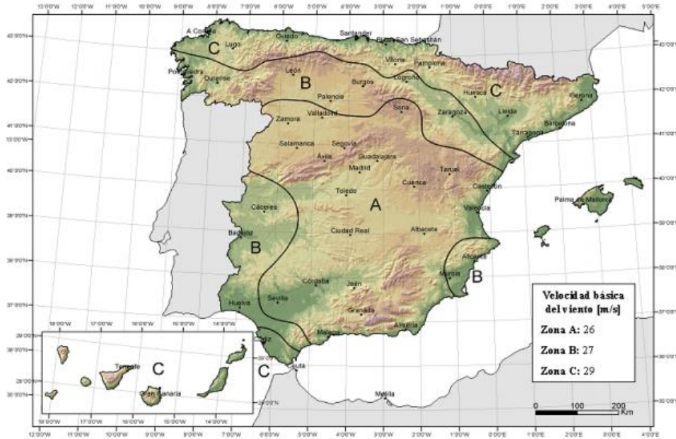
Figura 2.5.7 Valor de la velocidad básica de viento (Figura D.1 CTE DB SE-AE).
