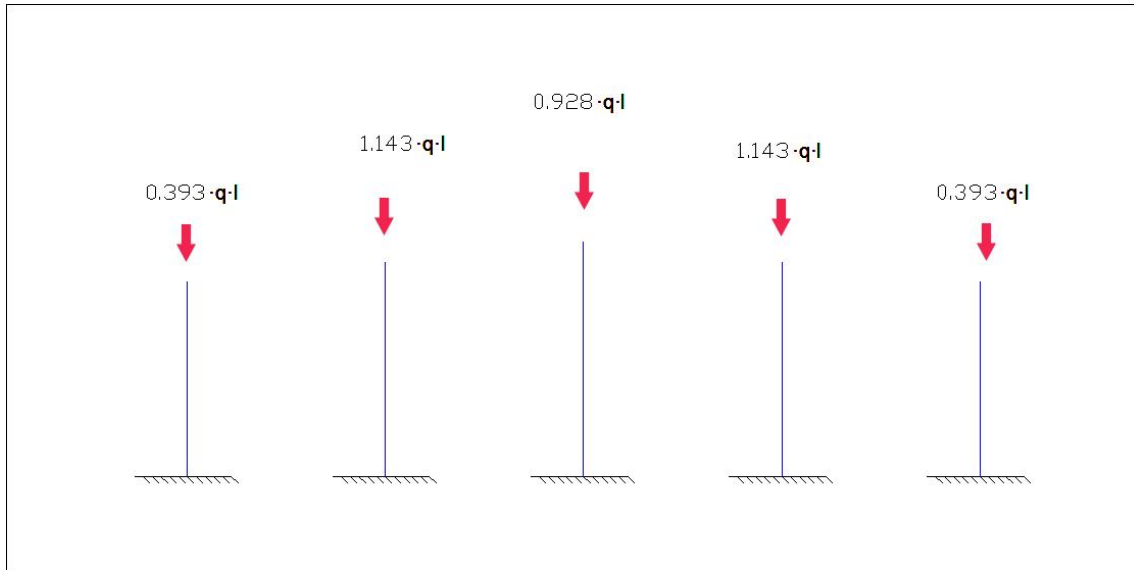
Figura 4.1.1 Axiles sobre pilares del pórtico de fachada.
