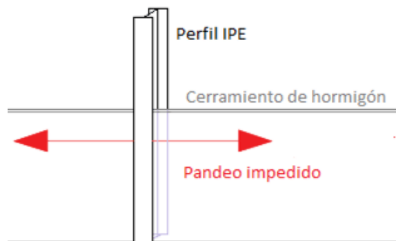
Figura 5.32. Esquema explicativo del coeficiente de pandeo en el plano XY. Fuente: http://www.ingrafer.es
