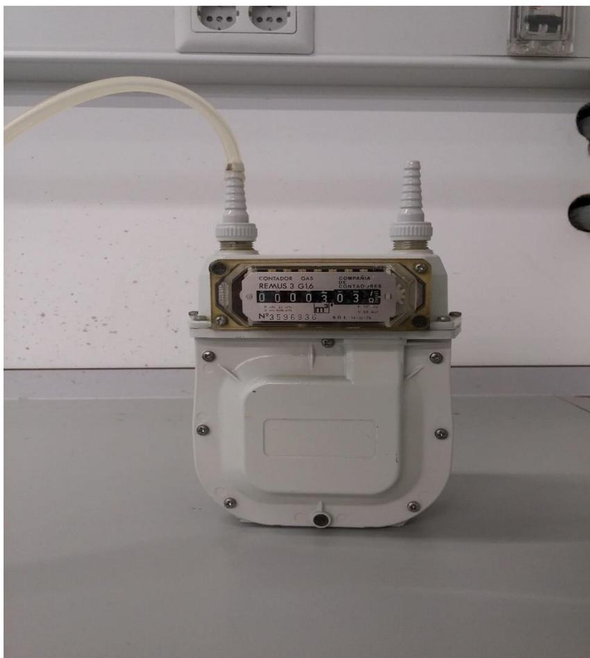
Figura 6. Contador utilizado para calibrar el caudal de aire
