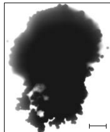
Figura 4. Microfotografía electrónica de transmisión de las partículas compuestas con la proporción de monómero:magnetita 4:1. Longitud de la barra: 2 μm.
