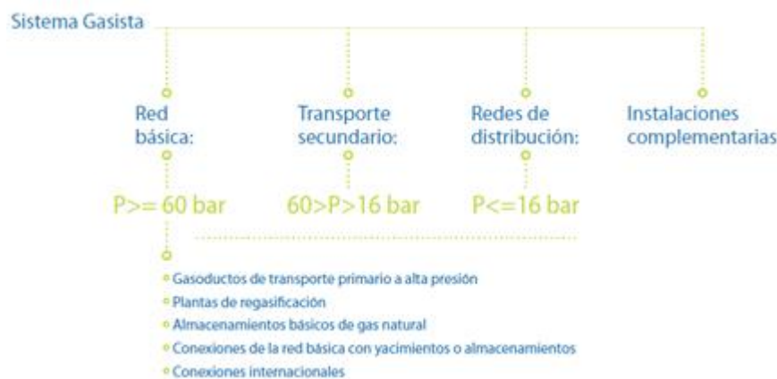
Figura 2.27. Red de transporte y distribución del gas natural (Fuente: Enagás)
