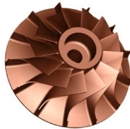
Figura 3.14. Rueda de expansión (Fuente: Atlas Copco)
