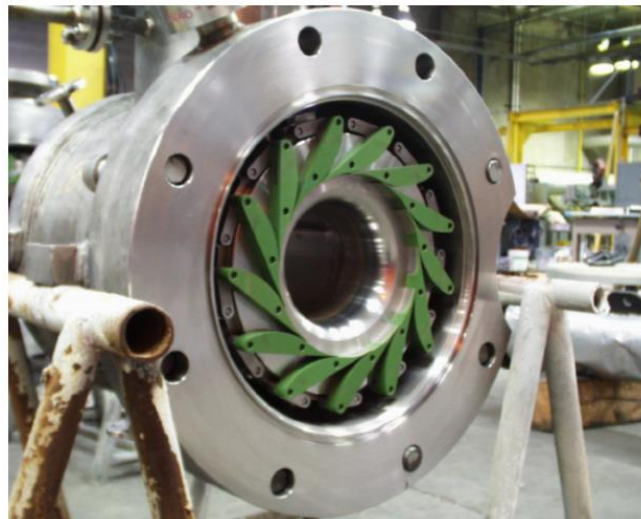
Figura 3.24. Carcasa de una turboexpander con IGVs instalados. (Fuente: Atlas Copco)
