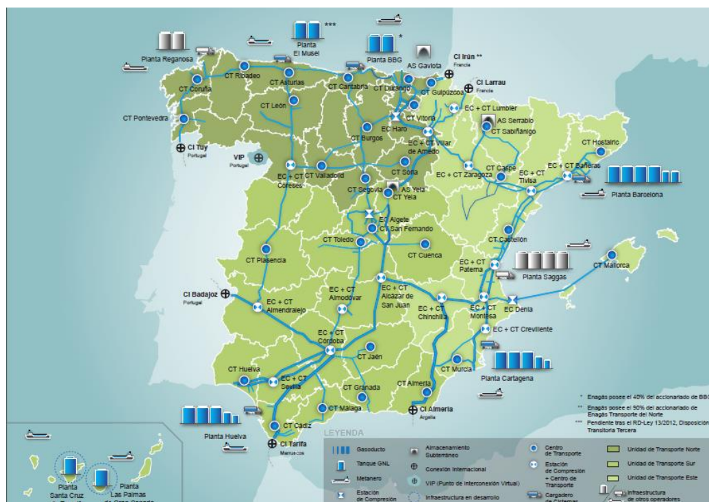
Figura 4.1: Infraestructuras gasistas en España. (Fuente: Enagás)
