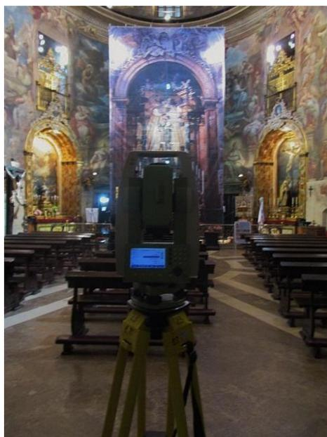
Figura 4.3. Estación Total LEICA FlexLine TS02 sobre trípode.
