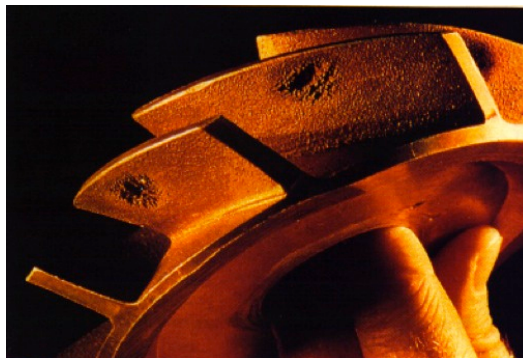
Figura 3. Ejemplo corrosión por erosión, Widman International SRL [2015].
