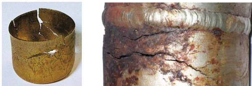
Figura 4. Ejemplo corrosión por agrietamiento, JN Aceros Blog y Trytech [2015].
