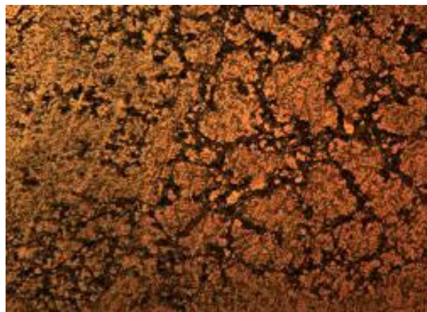
Figura 8. Ejemplo corrosión intergranular, G2MT Labs [2014].
