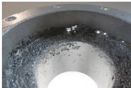
Figura 5. Ejemplo corrosión por picadura, High Seas Hydraulics [2014].
