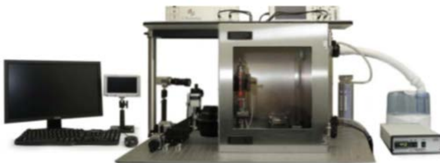
Figura 15. Equipo de la sonda Kelvin, KP Technology [2005].
