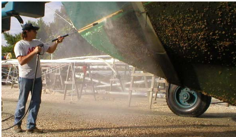
Figura 13. Rugosidad adquirida a lo largo de la vida del buque, Civantos, D. [2011]
