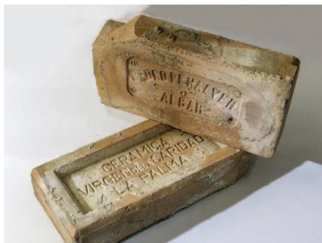
[FIG. 6] LADRILLOS PRENSADOS PROCEDENTES DE DERRIBOS DE EDIFICIOS DE LA CIUDAD, EN LA ZONA DEL MONTE SACRO. ARRIBA, LADRILLO PRENSADO DE BORDE RECTO DE LA CERÁMICA DE 'PEDRO PEÑALVER, EN EL ALGAR. ABAJO, LADRILLO PRENSADO DE BORDE BISELADO DE LA CERÁMICA 'VIRGEN DE LA CARIDAD', EN LA PALMA.
