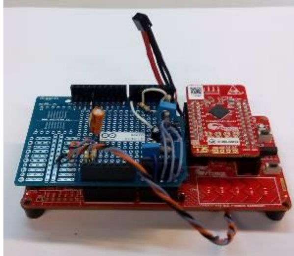
Ilustración 4-8. Diseño final del shield conectado al PSoC
