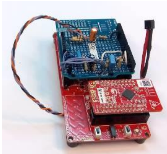
Ilustración 4-9. Diseño final del shield conectado al PSoC
