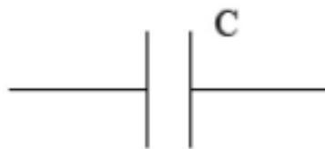
Figura 14: Representación simbólica de una monopuerta capacitiva
