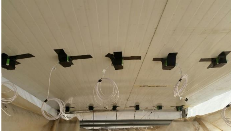
Figura 4.11. Sondas de temperatura de aire (EE431) vistas desde la cara posterior del panel aislante.
