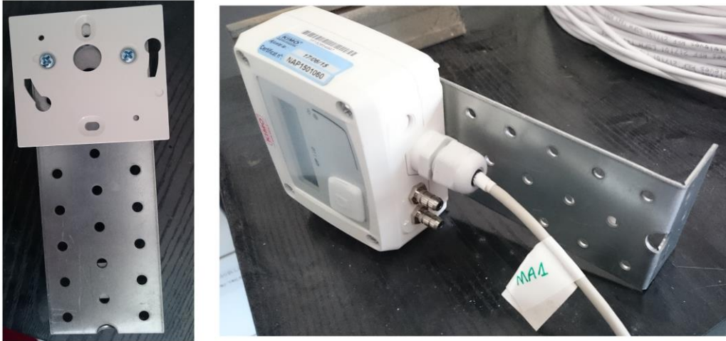
Figura 4.13. Transductor de presión diferencial colocado en su soporte.
