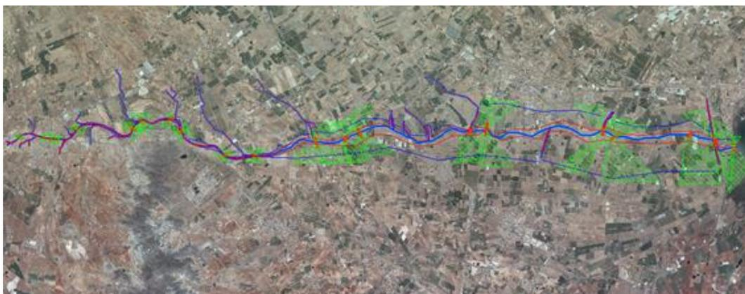
*Figura 5.20. Creaci3n de las 3reas de flujo inefectivas debido a la presencia de puentes a lo largo de la Rambla del Albuji3n.*
