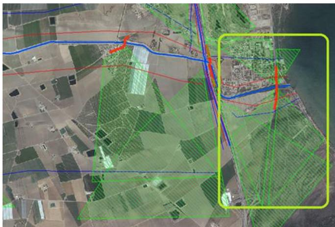
*Figura 5.23. Creación de las áreas de flujo inefectivas del puente de la zona baja de la Rambla del Albujión.*
