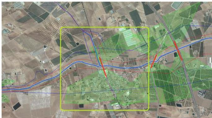
*Figura 5.22. Creación de las áreas de flujo inefectivas del puente de la zona media de la Rambla del Albujión.*
