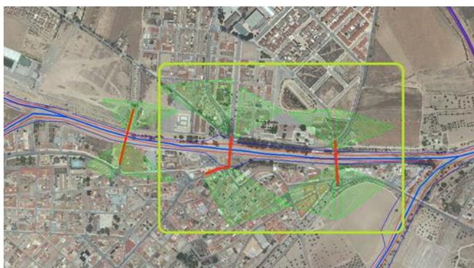
*Figura 5.21. Creaci3n de las 3reas de flujo inefectivas de los dos puentes de la zona alta de la Rambla del Albuji3n.*
