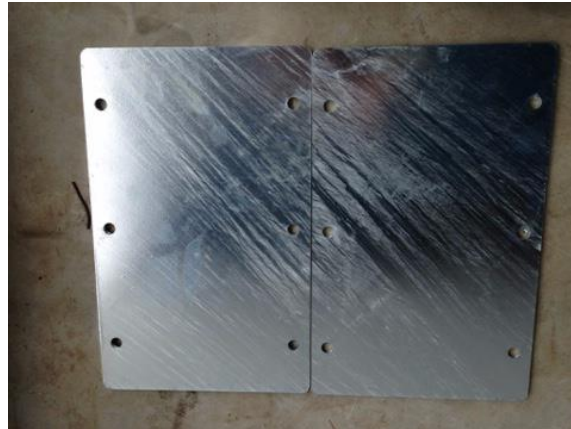
Figura 4.1. Placas de acero galvanizado pasivadas
