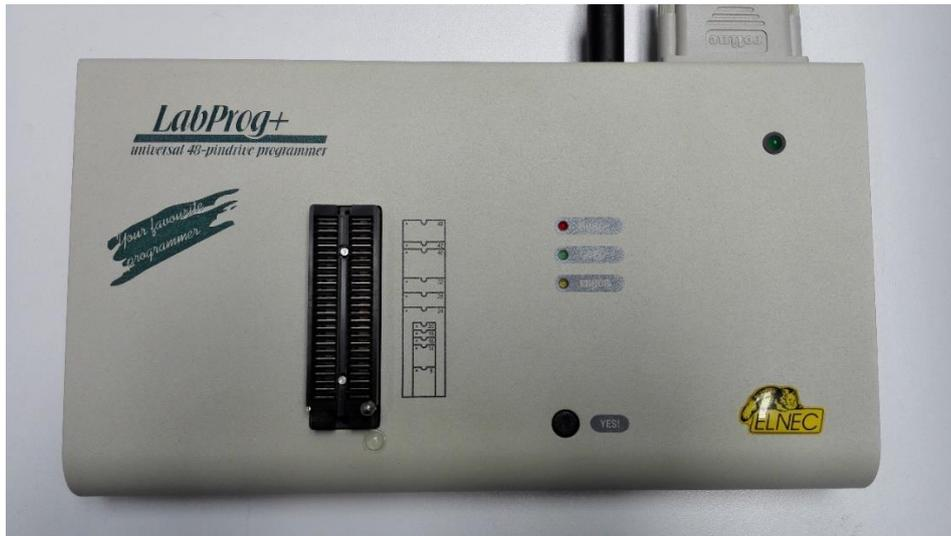
Figura B.3 - Programador LabProg+ de El nec
