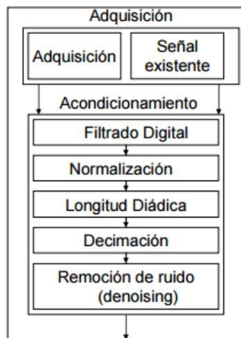
Figura 1.8 - Diagrama de bloques de la etapa de acondicionamiento digital
