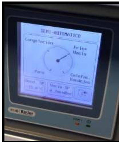
IMAGEN 12: PANTALLA TACTIL DE PUESTA EN MARCHA/PARO DE LIOFILIZADOR DE LA SERIE LYOQUEST
