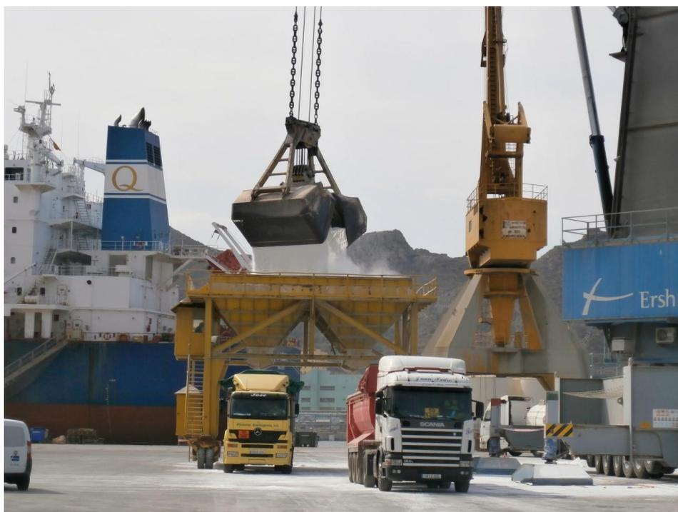
**Figura 3.5. Descarga de cemento desde la grúa a las tolvas y de éstas a los camiones. Fuente: Propia (Visita guiada al Puerto de Cartagena)**
