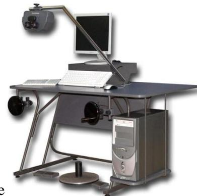
Fig. 20.18. Estación fotogramétrica digital
