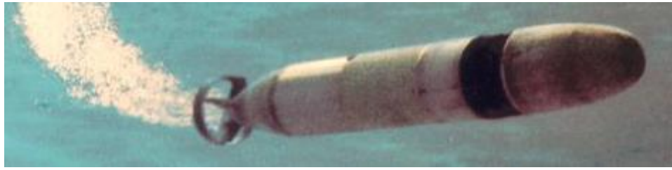
Figura 1-19: EMATT desarrollado por Lockheed Martin’s Sippican Underwater.
