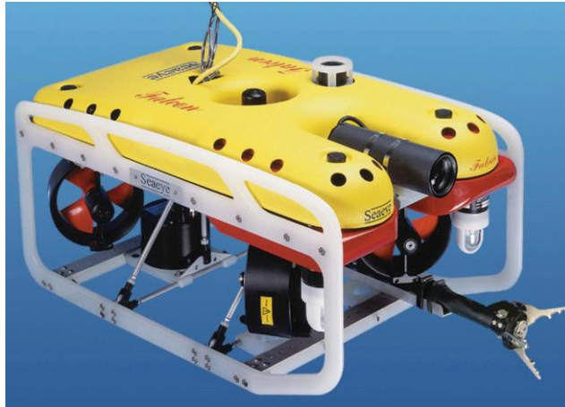
Figura 1-13: ROV Falcon de SAAB para explotaciones petrolíferas Off-Shore.
