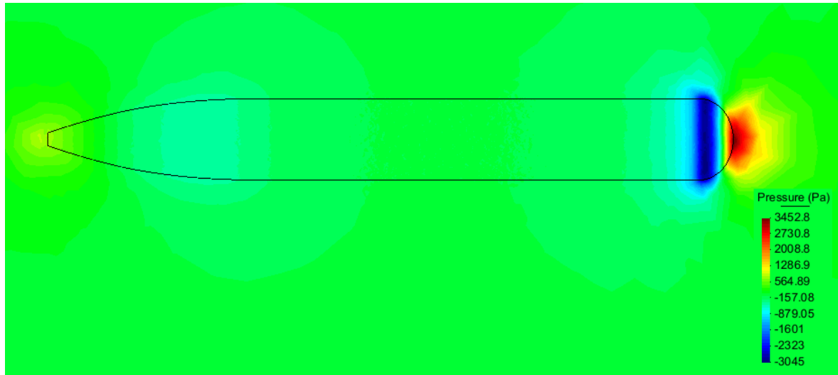
Figura 6-16: Distribución de presiones en el vehículo sin apéndices en 3D a 5 nudos.
