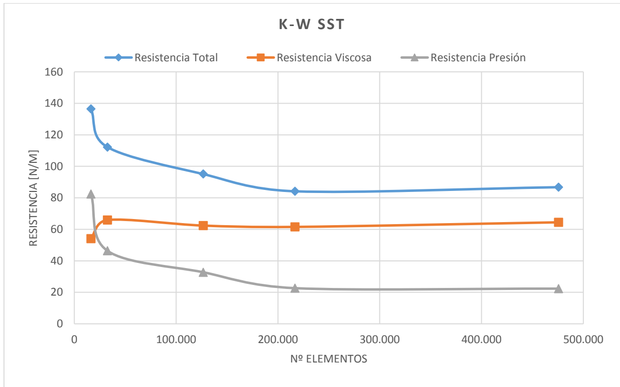
Figura 6-12: Variación resistencia de presión y viscosa para 5 nudos y modelo K- \omega SST.
