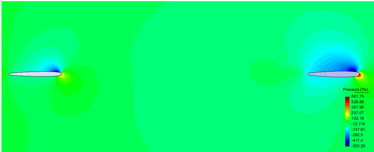
Figura 7-20: Distribución de presiones en el timón y GPS a 2 nudos y ángulo de ataque (guiñada) de 4°.
