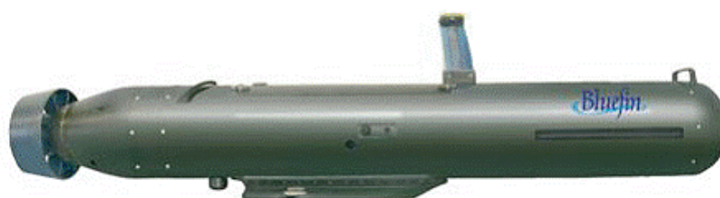
Figura 1-17: Bluefin-9 desarrollado por Bluefin Robotics Corp.
