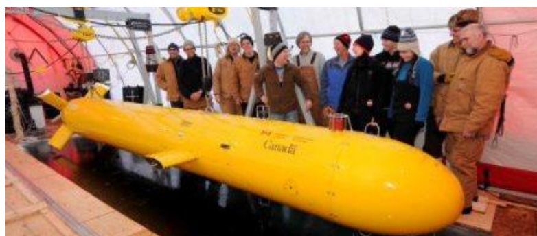
Figura 1-29: ISE Theseus desarrollado por International Submarine Engineering (Canada).
