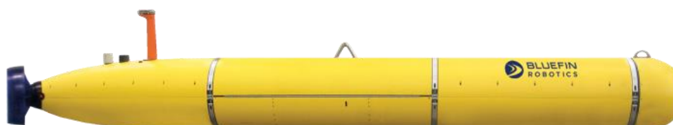
Figura 1-24: Bluefin-21 desarrollado por Bluefin Robotics (USA).
