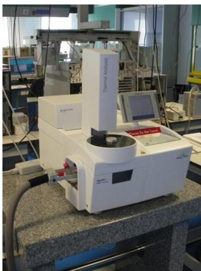
Figura 8. Analizador TG modelo TGA/DSC 1 HT de Mattler - Toledo
