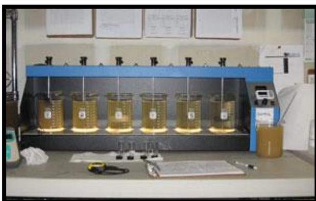
Figura 2. Equipo Jar - test
