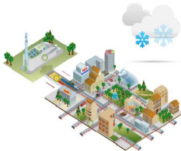
Ilustración 36. Esquema de red de distribución de frío y calor
