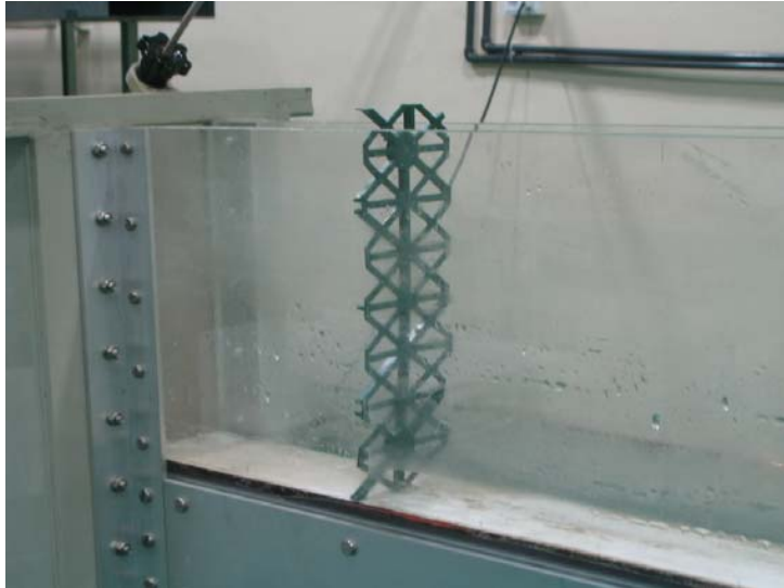
Figura 3.15(a). Tranquilizador de flujo aguas debajo de la compuerta
