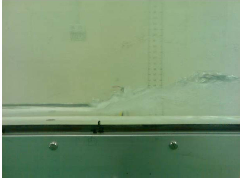
Figura 3.18. Resalto hidráulico estabilizado a 28 cm de la compuerta
