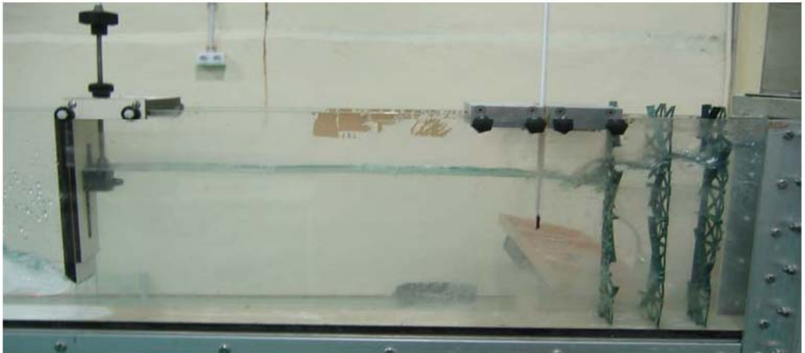
Figura 3.14. Tranquilizadores de flujo aguas arriba de la compuerta, Márquez (2006)
