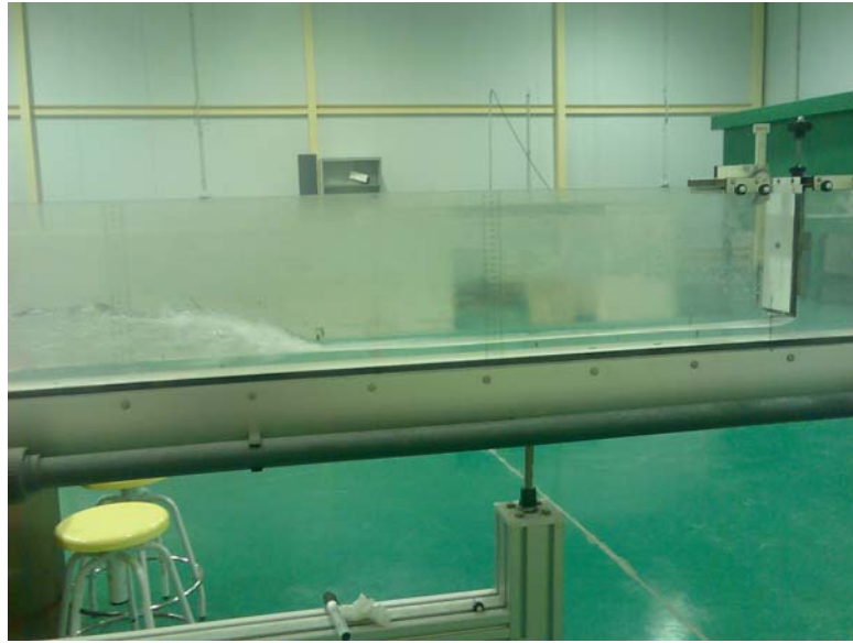
Figura 3.19. Resalto hidráulico estabilizado a 56 cm de la compuerta
