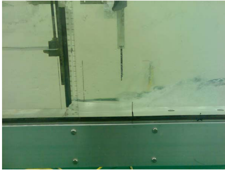
Figura 3.17. Resalto hidráulico estabilizado a 14 cm de la compuerta
