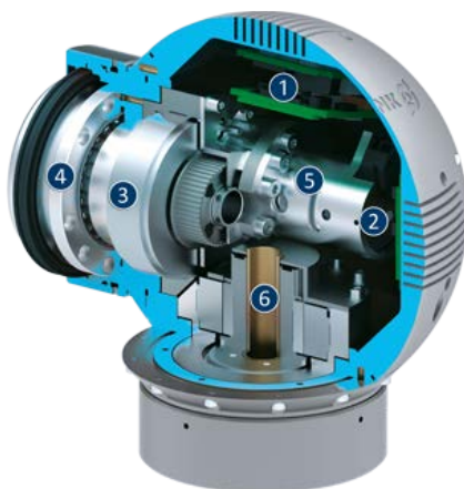
Ilustración 5.5 - Estructura interna de la articulación Powerball
