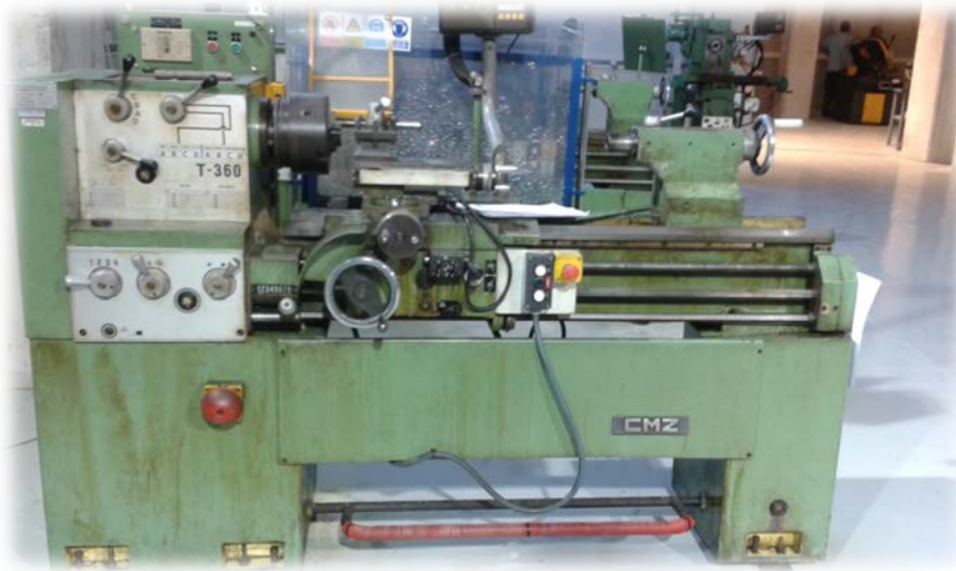
Figura 24. Torno del Taller de Fabricación Mecánica en el ELDI. Vista de sistemas de seguridad disponibles. Fuente: Elaboración propia.
