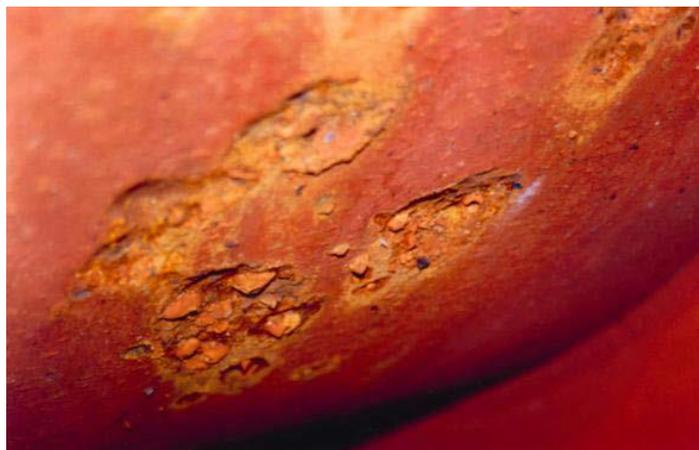
Foto Corrosión cáustica en fogón de una caldera.
