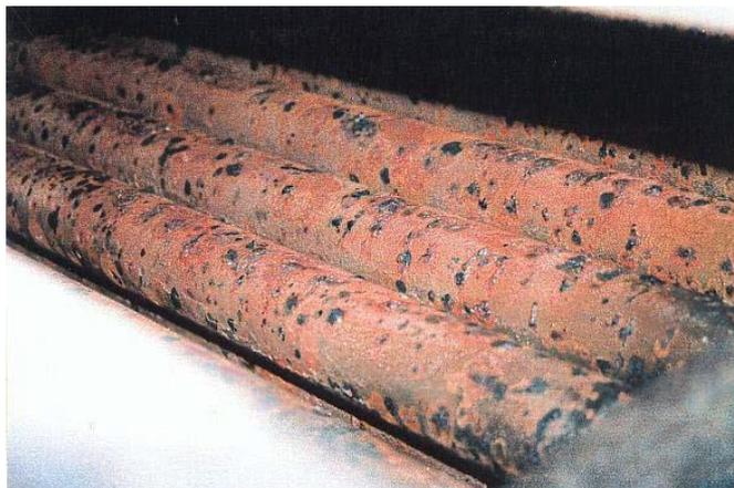
Foto Corrosión por oxígeno o “pitting”.
