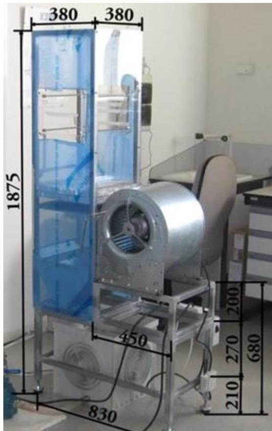
Figura 9. Imagen de la torre de refrigeración experimental
