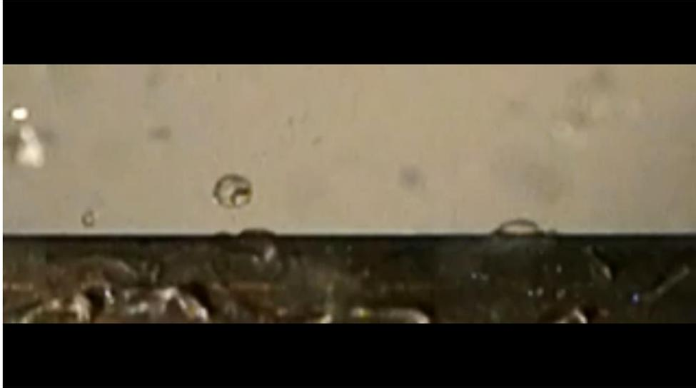
**Figura 42. Gotas desprendidas del borde superior de la placa**
